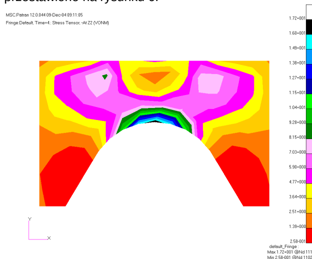
Rys.6. Naprężenia zredukowane [MPa] w małych żebrach usztywniających
