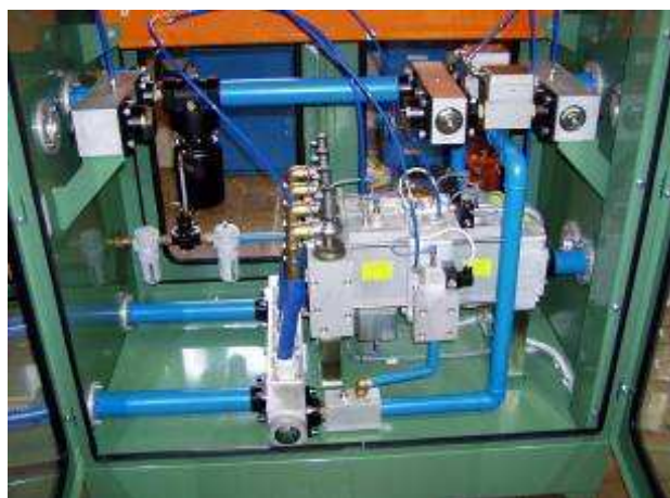
Rys.5. Główne przewody zasilające
