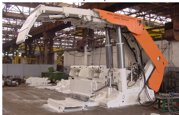
Rys.7. Obudowa Glinik 22/47-POz (2x5529 kN) ze stropnicą wychylno-wysuwną
