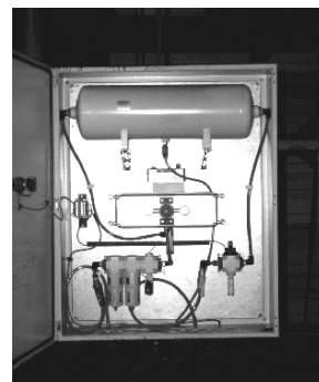
Rys.5. Urządzenie BOSS 2000 w osadzarce OM20P3eR: a) stacyjki ręcznego sterowania siłownikami i regulacji ciężaru właściwego pływaków, b) sterowane przepustnice wody dolnej, c) stacja przygotowania powietrza sterującego
