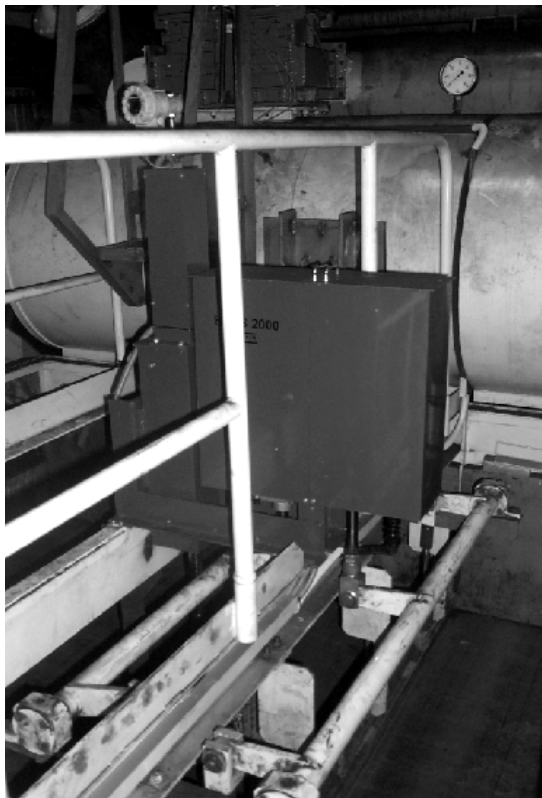
Rys.4. Urządzenie BOSS 2000 – osadzarka OM20P3eR: a); b) urządzenie pomiarowo-wykonawcze przedziału roboczego
