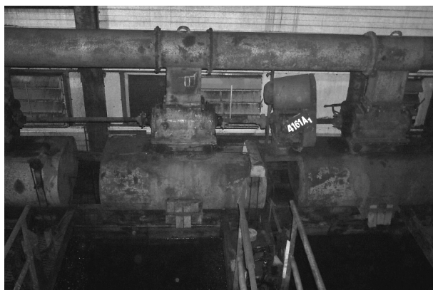
Rys.1. Osadzarka OM18 w KWK Rydułtowy-Anna RI: a) instalacja powietrza roboczego; b) urządzenie sterowania odbiorem produktu ciężkiego
