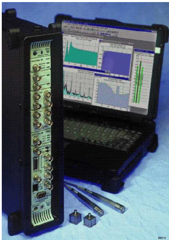
Rys.2. System do pomiarów wibroakustycznych produkcji Bruel&Kjaer
