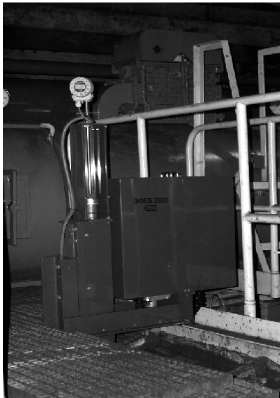
Rys.4. Urządzenie BOSS 2000 – osadzarka OM20P3eR: a); b) urządzenie pomiarowo-wykonawcze przedziału roboczego
