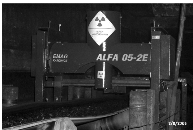
Rys.7. Popiołomierz ALFA 05/2E – taśma z odpadami
