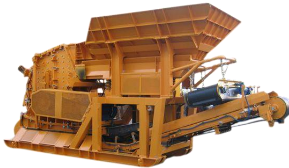
Rys. 15. Układ mobilny o dużej wydajności do przeróbki gruzu budowlanego i granitu [25]
