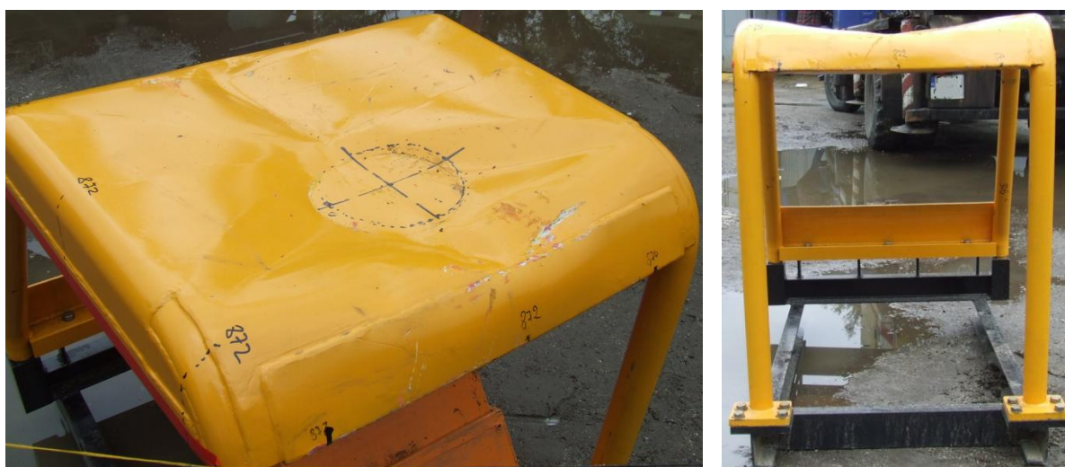
Rys. 8. Odkształcenie poszycia górnego konstrukcji ochronnej będące efektem badań niszczących [1]
