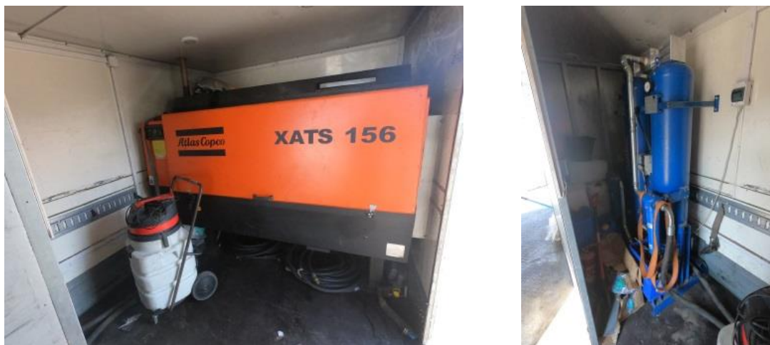
Rys. 1. Urządzenie przygotowujące mieszankę gazów zabudowane w samochodzie technologicznym [10]
