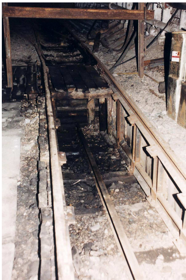
Rys.6. Dolna komora garażowa przeznaczona dla wózka hamulcowego
