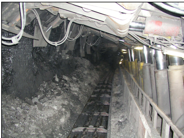
Rys.1. Widok ściany 7/II z obudową MOZ-Pioma-17/37 POz
