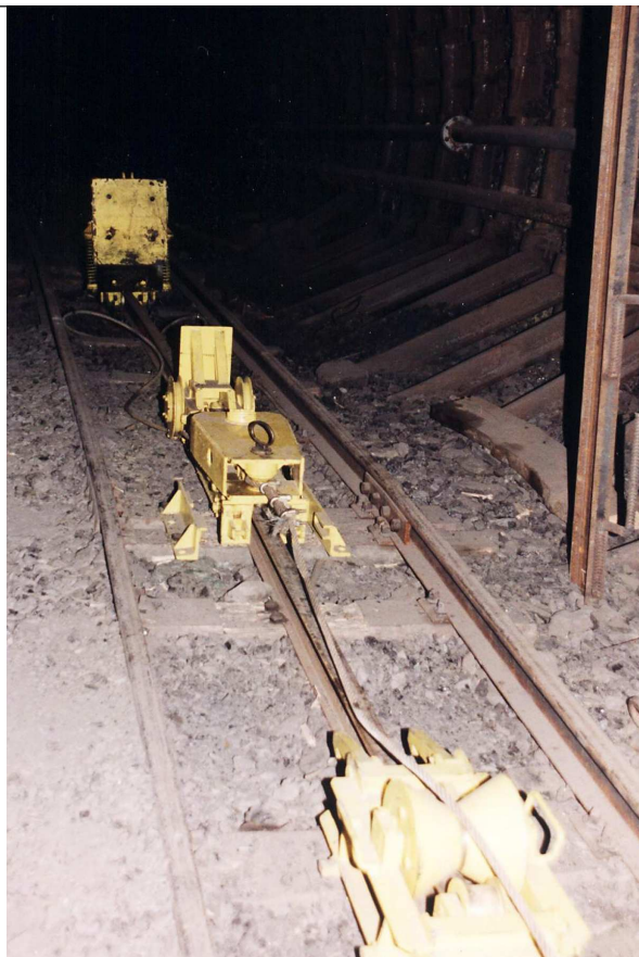
Rys.8. Zestaw transportowy: wózek hamulcowy, wózek linowy, rolka i wybierak liny
