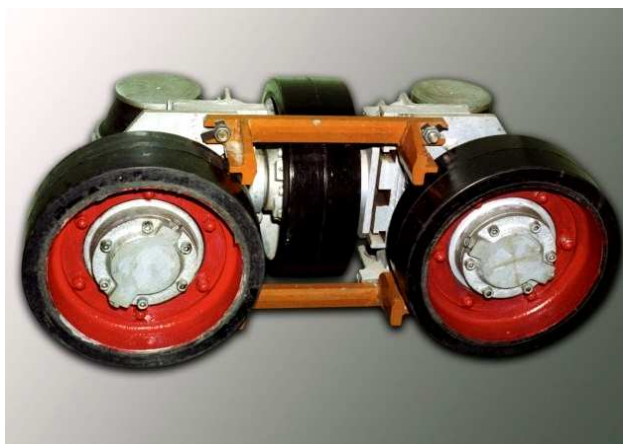
Rys.3. Przykład rozwiązania prowadnicy krążkowej z symetrycznym amortyzatorem zespolonym PHH
