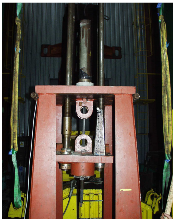
Rys.3. Przykładowy widok kotwi zamocowanej w walcu badawczym i obciążonej trawersą w stanowisku badawczym
