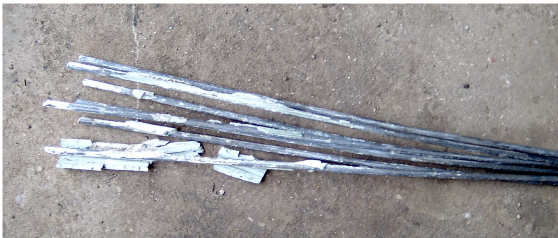
Rys.10. Ścięcie połączenia między żerdzią a klejem Lokset podczas badania kotwi typu IR-4W
