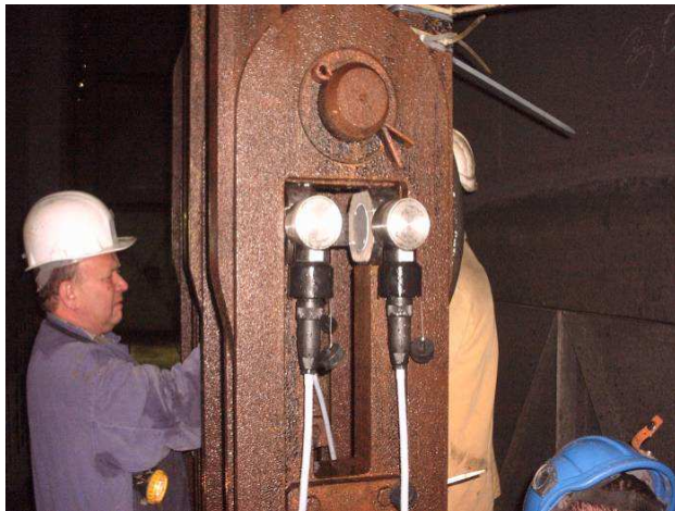
Rys.8. Wkładki WPS-Ec w zawieszeniu naczyń wyciągowego szybu 1.3
