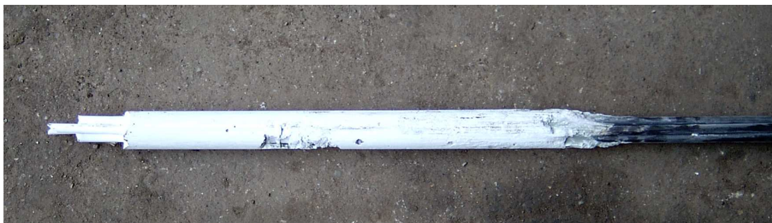
Rys.11. Ścięcie połączenia między betonem a klejem Lokset podczas badania kotwi typu IR-4W
