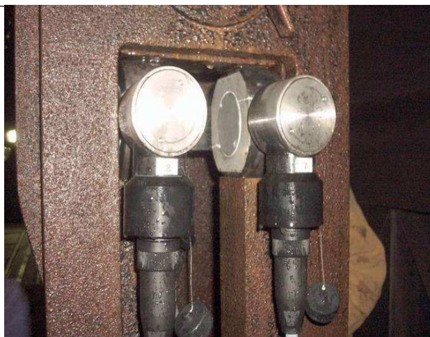
Rys.2. Wkładki WPS-Ec zabudowane w łączniku do zmiany długości lin produkcji RYFAMA
