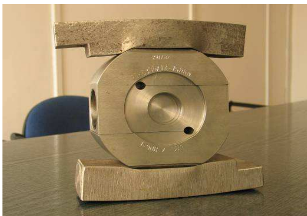
Rys.5. Czujnik siły i wkładki dystansowe po badaniach
