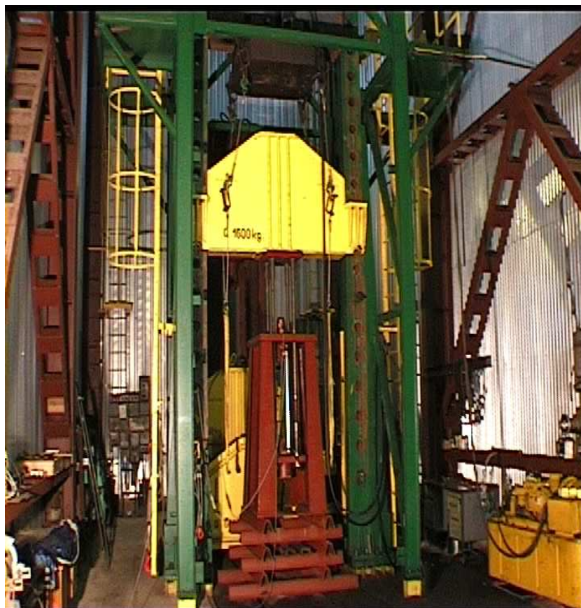
Rys.2. Stanowisko do badania kotwi w skali naturalnej, za pomocą uderzenia masy 1 – masa uderowa, 2 – trawersa statycznie obciążająca badaną kotew, 3 - rama stanowiska z badaną kotwią oraz oczujnikowaniem
