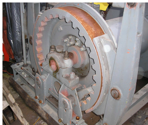
Rys.3. Kołowroty typu KUBA-5 i KUBA-10 w trakcie remontu
