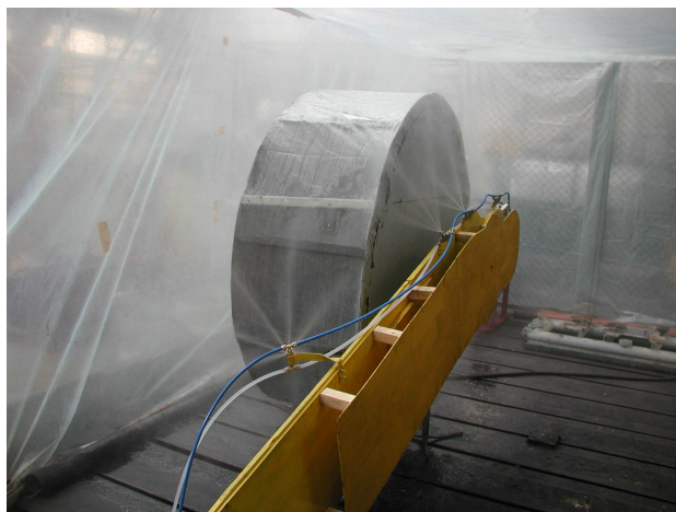
Rys.7. Model organu urabiającego z ładowarką – badania stanowiskowe
