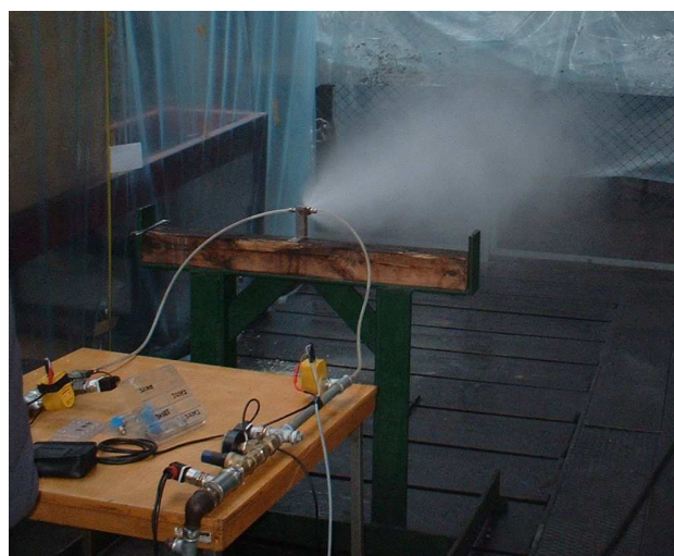
Rys.3. Badania dyszy dwuczynninkowej o wielostożkowym kształcie strumienia
