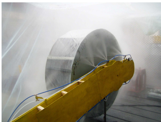
Rys.9. Model instalacji zraszającej z ramieniem kombajnu KSW-475
