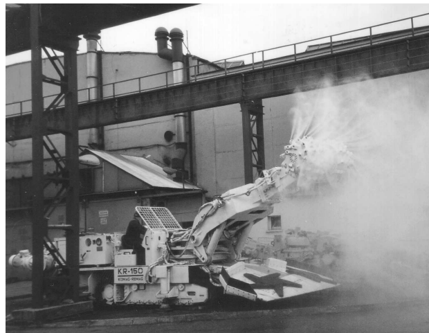
Rys.25. Kombajn KR-150 z wewnętrznym, wysokociśnieniowym zraszaniem sektorowym. Wspólny projekt AGH, REMAG – Katowice, KOMAG – Gliwice
