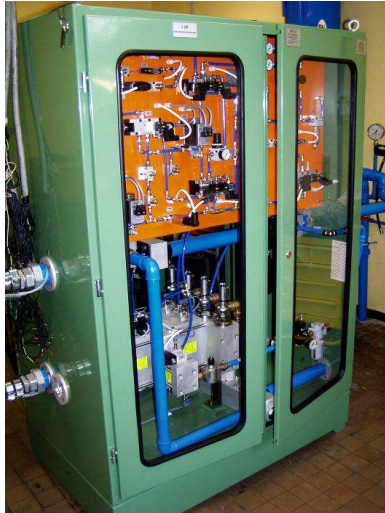
Rys.9. Elektropneumatyczny zespół sterowania hamulców ZSHP
