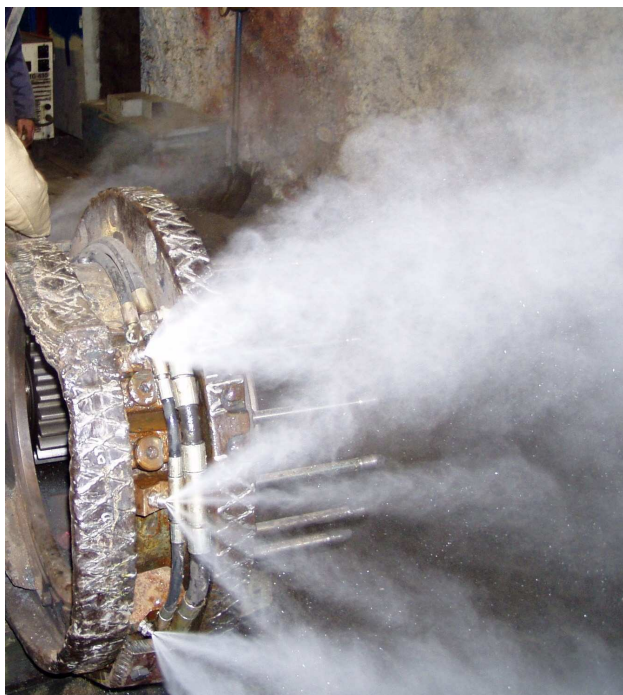
Rys.10. Instalacja zraszania powietrzno-wodnego na ramieniu kombajnu KSW-475
