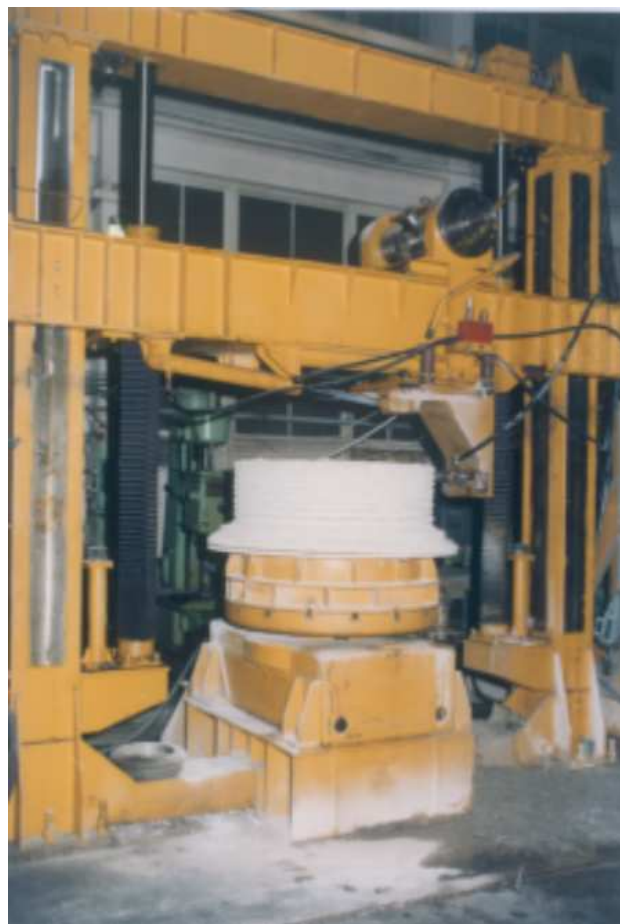
Rys.4. Stanowisko do badań pojedynczych narzędzi - karuzelówka
