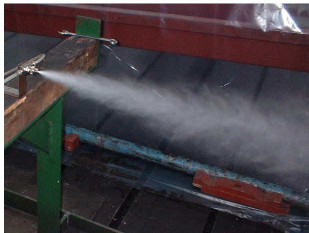
Rys.2. Badania dyszy dwuczynninkowej o stożkowym kształcie strumienia
