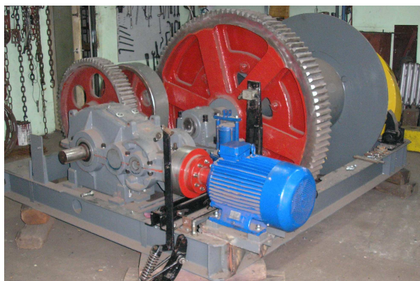
Rys.3. Kołowroty typu KUBA-5 i KUBA-10 w trakcie remontu
