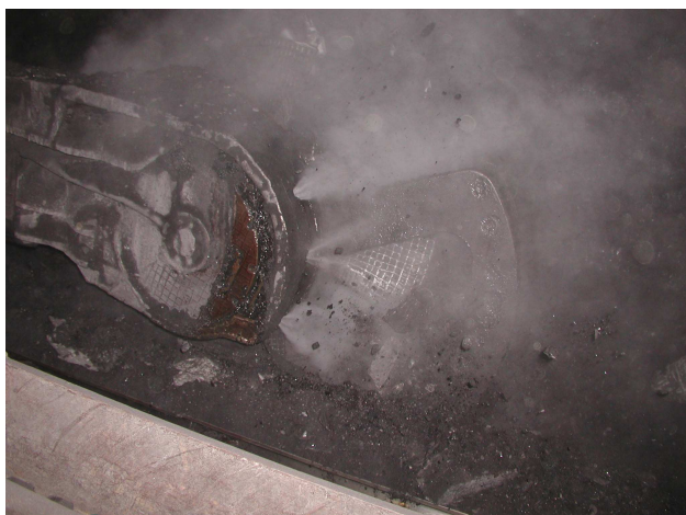
Rys.10. Badania eksploatacyjne instalacji zraszającej powietrzno-wodnej zabudowanej na kombajnie KSW-475 w LW „Bogdanka” S.A.
