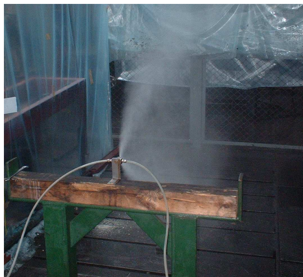
Rys.4. Badania dyszy dwuczynninkowej o płaskim kształcie strumienia
