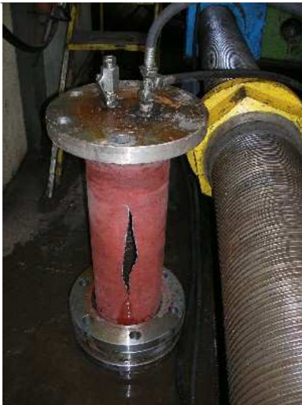
Rys.1. Badania stanowiskowe rurociągu
