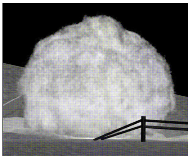
Rys.10. Symulacja wybuchu mieszaniny pyłu węglowego i powietrza za pomocą metody CFD [2]
