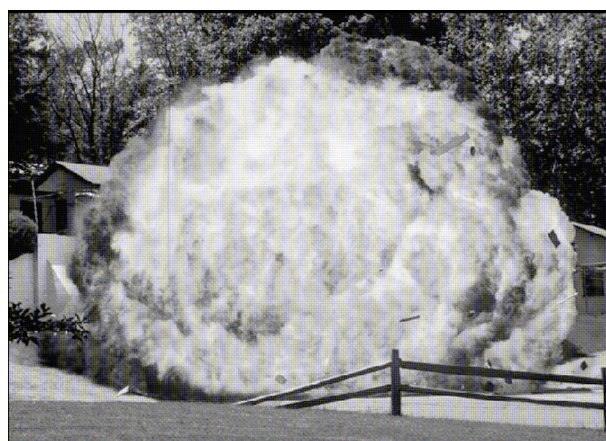
Rys.11. Badania doświadczalne wybuchu pyłu węglowego przeprowadzone w Brucetone Experimental Mine [2]
