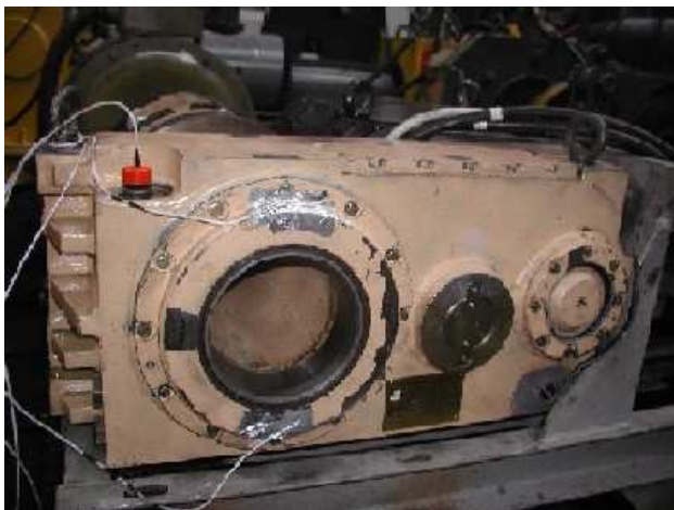
Rys.5. Rozmieszczenie czujników temperatury na badanej przekładni
