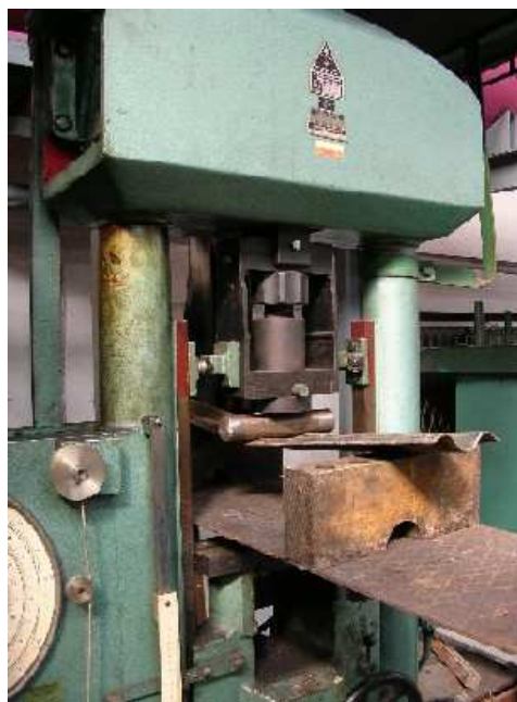
Rys.4. Badania stanowiskowe siatek okładzinowych
