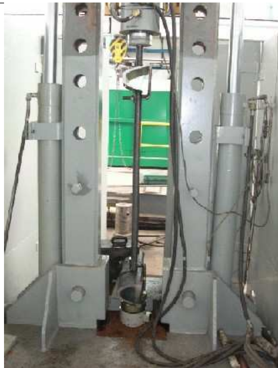
Rys.3. Badania stanowiskowe rozpór
