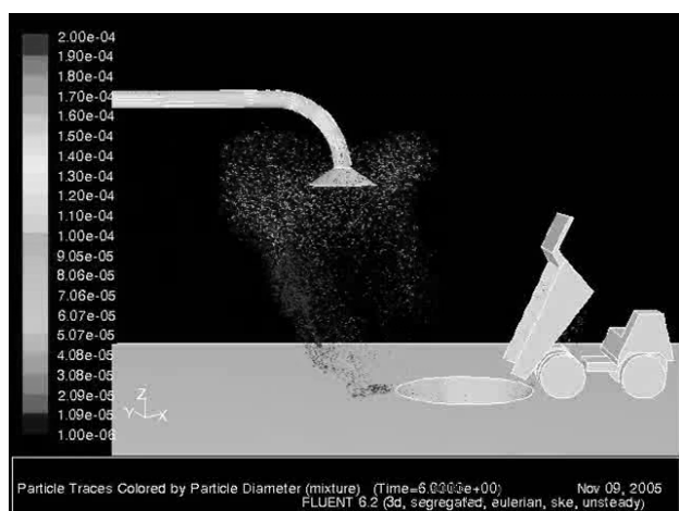
Rys.9. Ruch cząstek pyłu w powietrzu w 6 s symulacji
