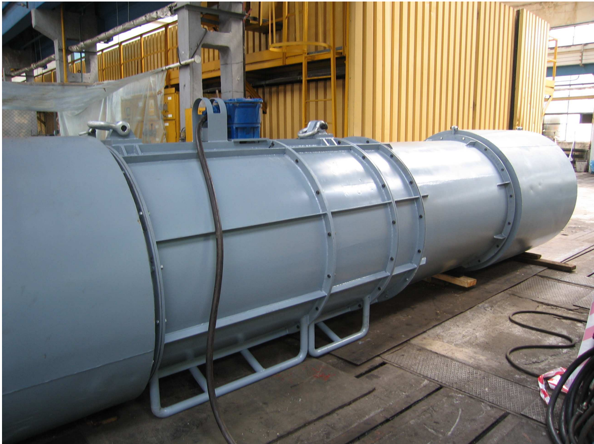
Rys.3. Widok wentylatora WLE/M-1200B/1 z tłumikami hałas na stanowisku badawczym w CMG KOMAG
