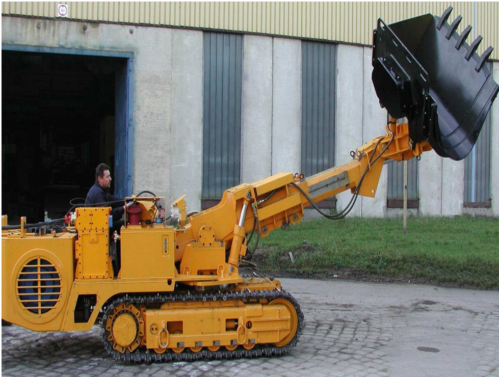
Rys.1. Ładowarka bocznie wysypująca ŁBT-1200 EH/LS-A z wysięgnikiem teleskopowym
