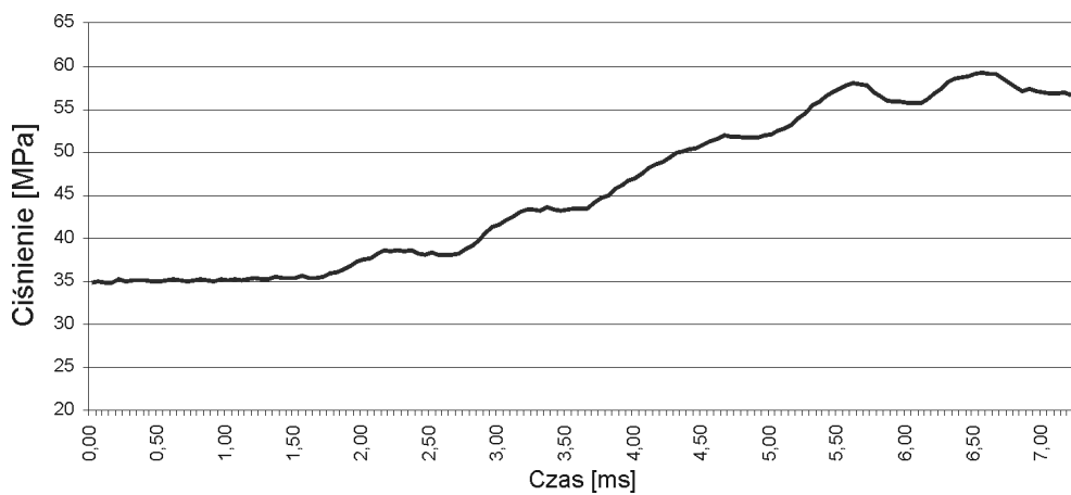
Rys.10. Test 2 (ciśnienie nominalne cieczy 35 MPa) – przebieg czasowy ciśnienia cieczy
