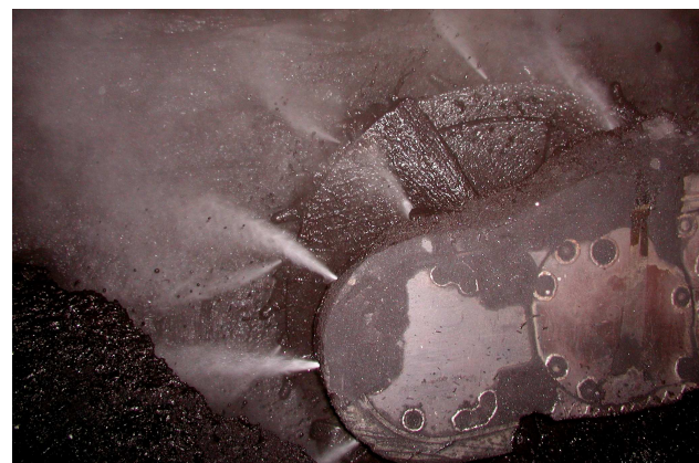
Rys.10. Zraszanie powietrzno-wodne z ramienia i organu urabiającego w czasie pracy kombajnu KSW-460NE w ścianie nr W-9 w KWK „Pniówek”
