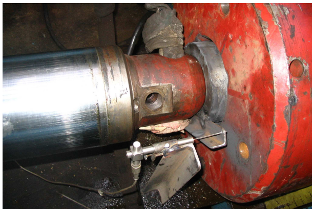
Rys.7. Czujnik indukcyjny do pomiaru przemieszczenia tłoka generatora obciążenia dynamicznego
