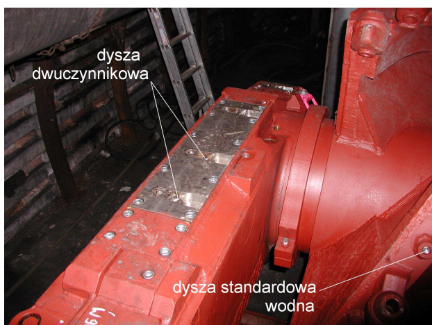
Rys.5. Usytuowanie dysz na ramieniu i organie kombajnu ścianowego typu KSW-460NE
