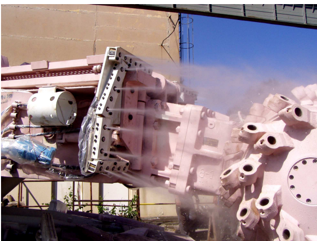
Rys.11. Próby działania kurtyny powietrzno-wodnej kombajnu chodnikowego typu R-200 na stanowisku REMAG-u
