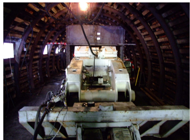
Rys.12. Wysięgnik z zabudowanymi bateriami zraszającymi kurtyny wraz z organem urabiającym, na stanowisku badawczym w KD „Barbara”
