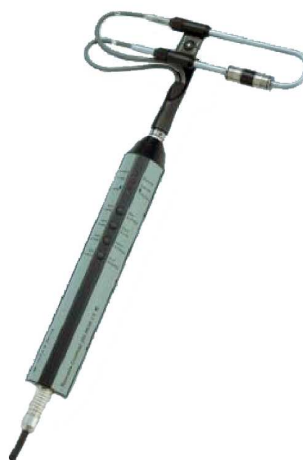
Rys.2. Sonda natężeniowa firmy Brüel&Kjær stosowana przez ITG KOMAG w pomiarach natężenia dźwięku i mocy akustycznej źródeł hałasu
