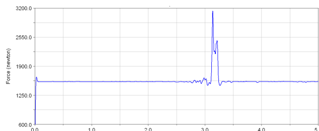
Rys.10. Siła wypadkowa utwierdzenia zawiesia Z6 [6]
