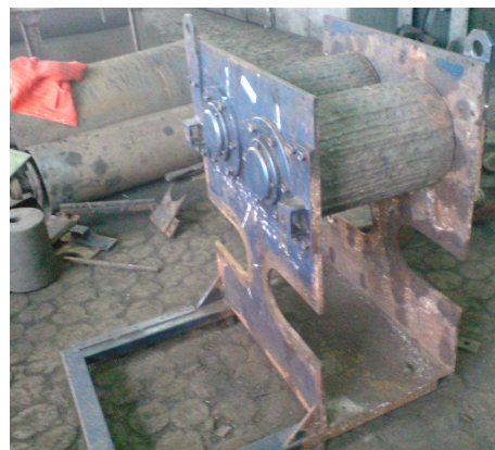
Rys.7. Wyeksploatowana kruszarka czterowalcowa, zdemontowane walce dolne, napędy i osłony [7]
