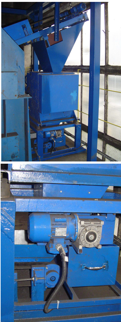
Rys.6. Kruszarka walcowa z obrotowym podzielnikiem próby w automatycznym systemie pobierającym próbkę z przesypu przenośnika taśmowego [7]
