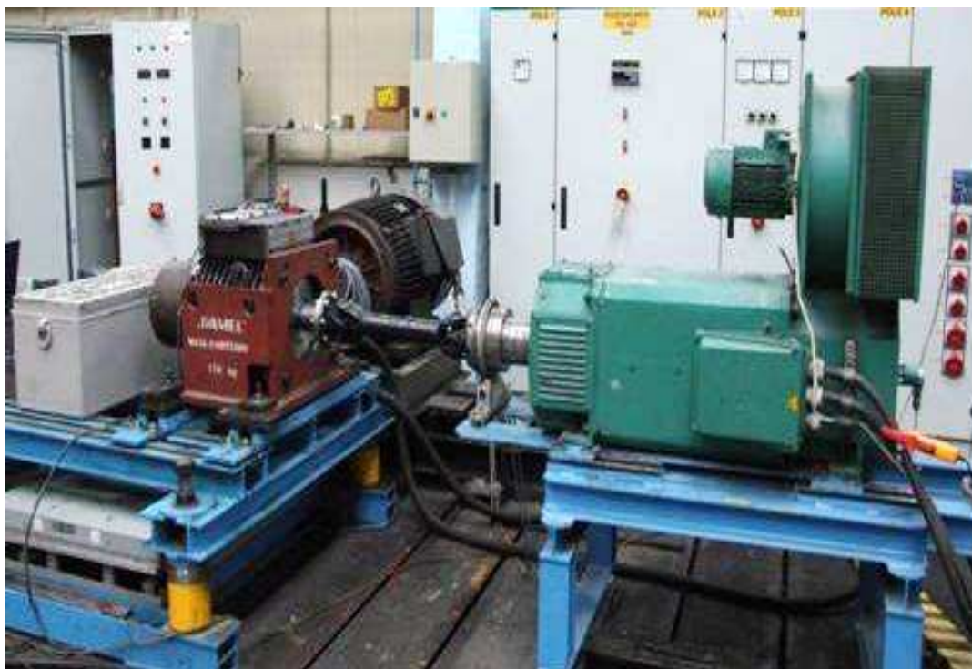
Rys.6. Bezszytkowy silnik synchroniczny z magnesami trwałymi na stanowisku badawczym [1]
