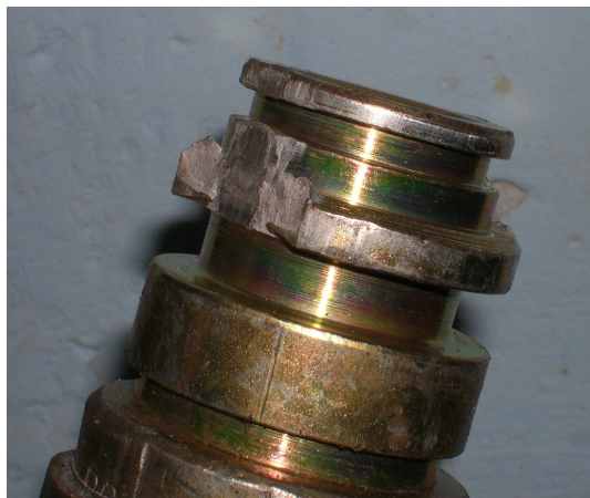
Rys.1. Ścięty kołnierz wtyku podczas badania złącza wtykowego na ciśnienie próbne
