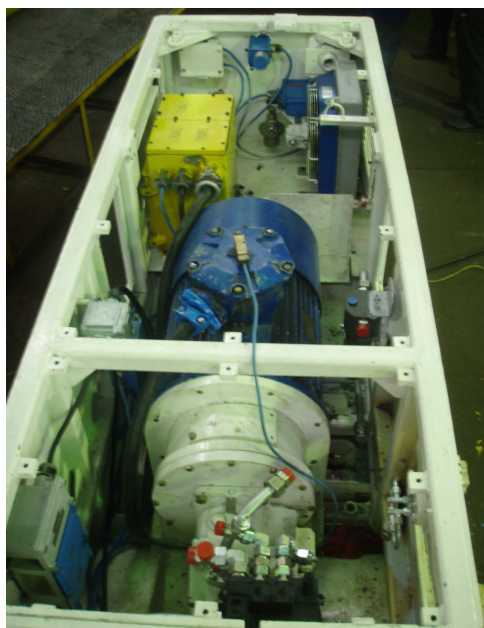
Rys.4. Elektrohydrauliczny napęd podwozia: a) widok ogólny, b) zespół pomp, c) wyłącznik ognioszczelny
