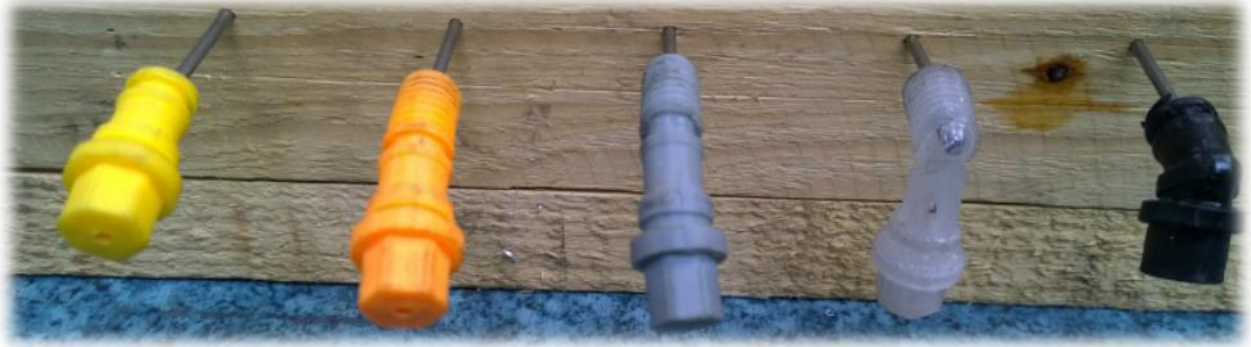
Rys. 5. Widok dysz po badaniach w komorze klimatycznej [11]
