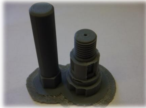
Rys. 2. Przykładowy wydruk dyszy oraz próbki do badań zmęczeniowych [11]
