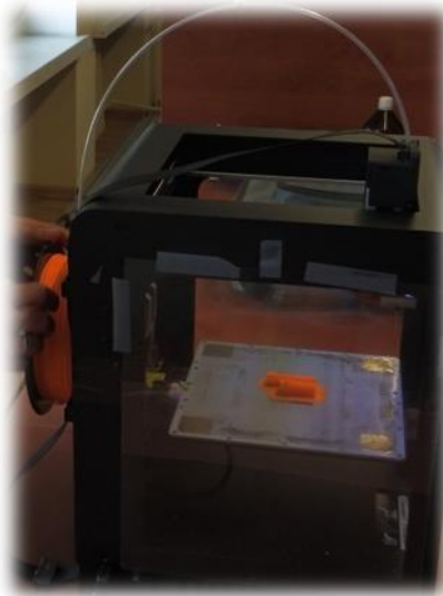
Rys. 1. Drukarka Zortrax M200 podczas druku dysz powietrzno-wodnych [11]
