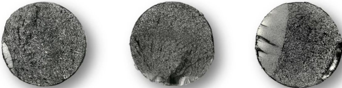
Rys. 10. Widok stref zmęczeniowych pęknięć pręta ogniów o zróżnicowanym położeniu ognisk pęknięć i wielkości strefy przełomu zmęczeniowego [opracowanie własne]
