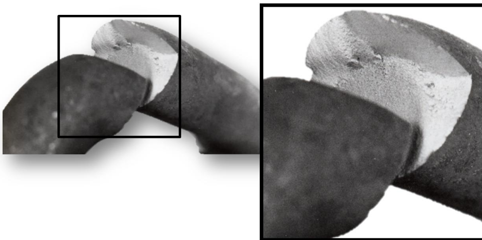
Rys. 11. Strefa całkowitego przełomu ogniwa pod kątem około 45° w stosunku do powierzchni [opracowanie własne]
