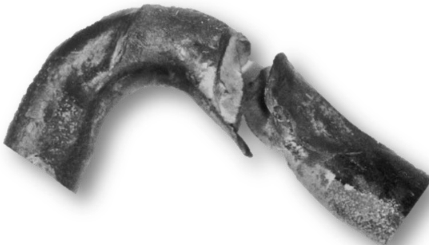
Rys. 13. Przełom ogniwa poziomego w strefie ubytków zużyciowych powstałych na skutek współpracy z zębami bębna łańcuchowego [opracowanie własne]
