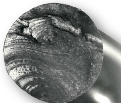
Rys. 8. Przykład pęknięcia zmęczeniowego ogniwa łańcucha w dwóch przekrojach: a) całkowity przełom pod kątem 45^\circ do powierzchni, b) ujawnione pęknięcie zmęczeniowe w innym przekroju [opracowanie własne]
