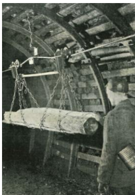
Rys. 1. Podwieszona kolej linowa [13]
