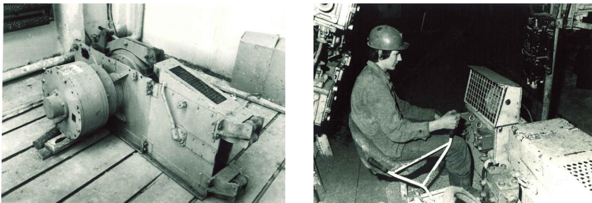
Rys. 7. Kołowrót i stanowisko sterowania napędu HNK-1 [12]
