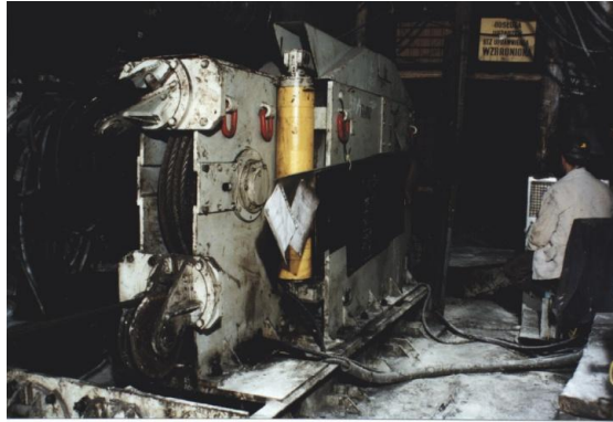
Rys. 8. Kołowrót linowy przewojowy napędu HNK-3 [12]
