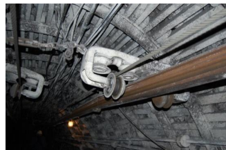
Rys. 3. Podwieszona kolej szynowa (trasa dwuteownikowa) z napędem linowym [13]
