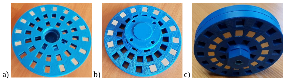
Rys. 8. Model badawczy sprzęgła doczołowego: a) tarcza 1, b) tarcza 2, c) sprzęgło zmontowane [3]
