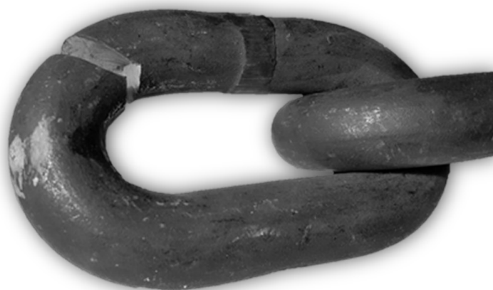
Rys. 2. Typowe pęknięcie zmęczeniowe ogniwa łańcucha ze strefą przełomu zmieniającego kierunek [opracowanie własne]
