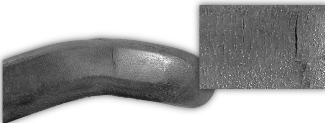
Rys. 5. Uszkodzenia ogniów ujawnione w wyniku próby przeginięcia w prostokątnej pryzmie: a) schemat obciążenia ogniwa podczas próby przeginięcia [9] (1. badane ogniwo, 2. wałek stalowy, 3. pryzma prostokątna), b) pęknięcie ogniwa łańcucha 30x108 w zgrzeinie, c) pęknięcia ogniwa łańcucha 34x126 na odcinku prostym [opracowanie własne]
