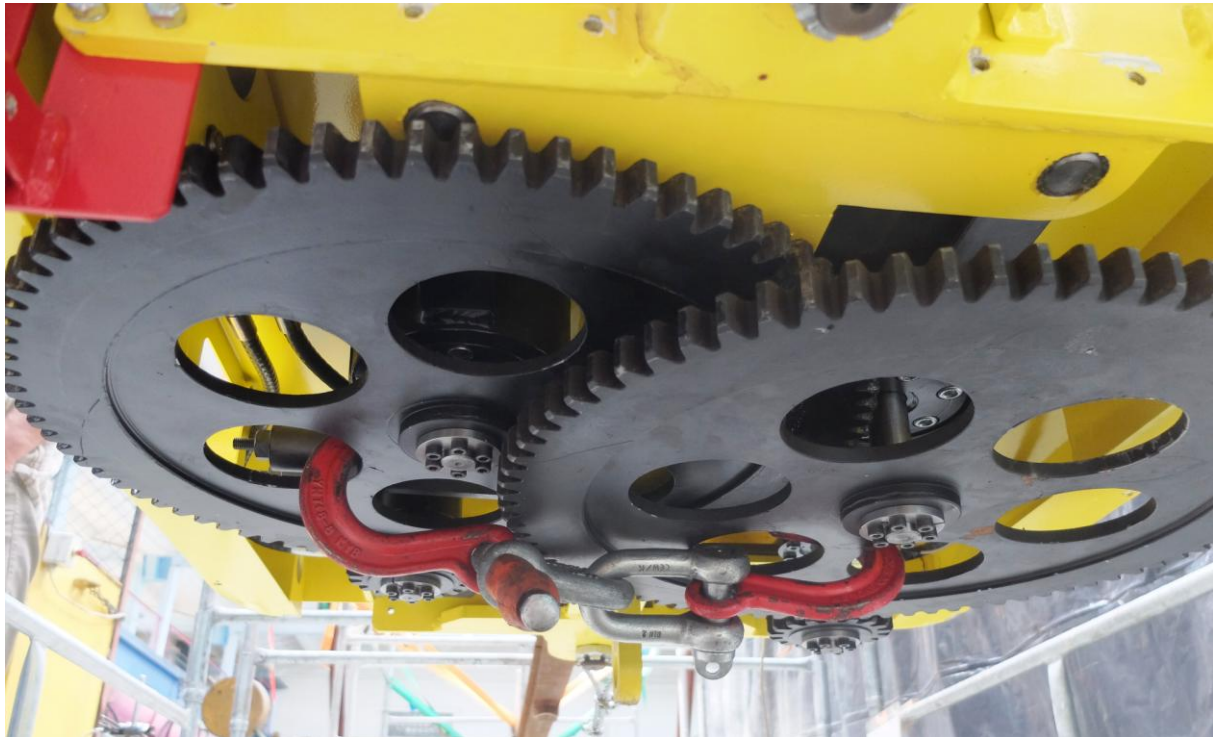
Rys. 5. Blokada zakładana na przekładnię urządzenia MUC-2 do badania siły inicjującej poślizg kół ciernych [2]
