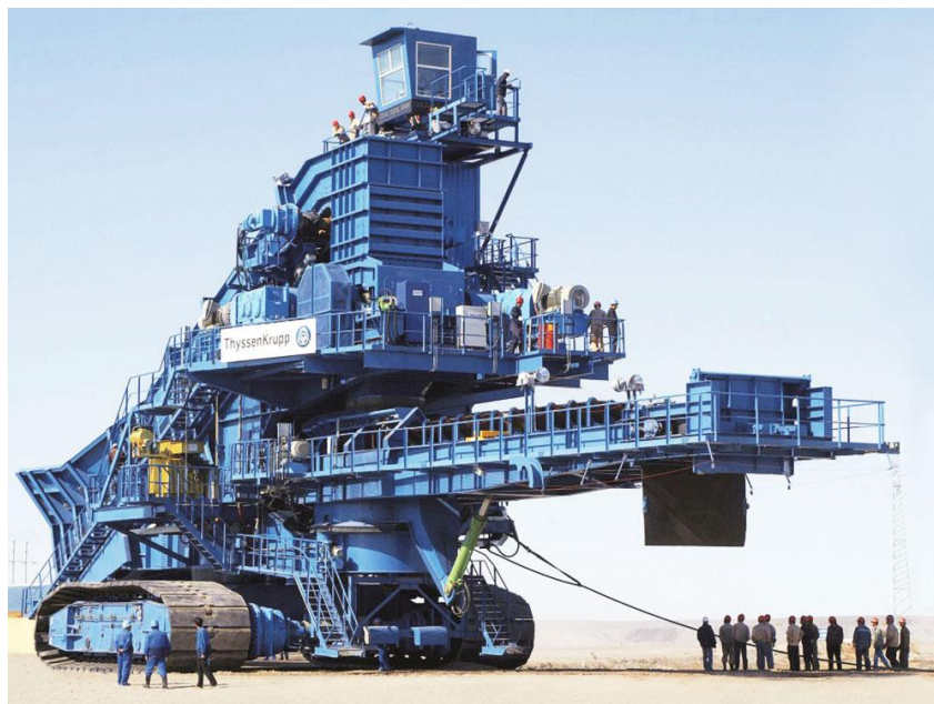
Rys. 12. Układ mobilny o dużej wydajności do przeróbki węgla [21]
