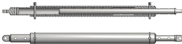
Rys. 8. Łącznik układu stabilizacji odrzwi [opracowanie własne]
