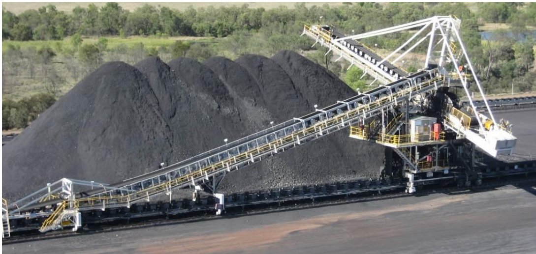
Rys. 3. Budowanie stosu przez układarkę [3]
