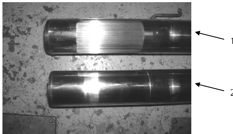
Rys.7. Widok uszkodzonych nurników stalowych
