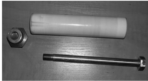
Rys.1. Widok uszkodzonego nurnika ceramicznego
