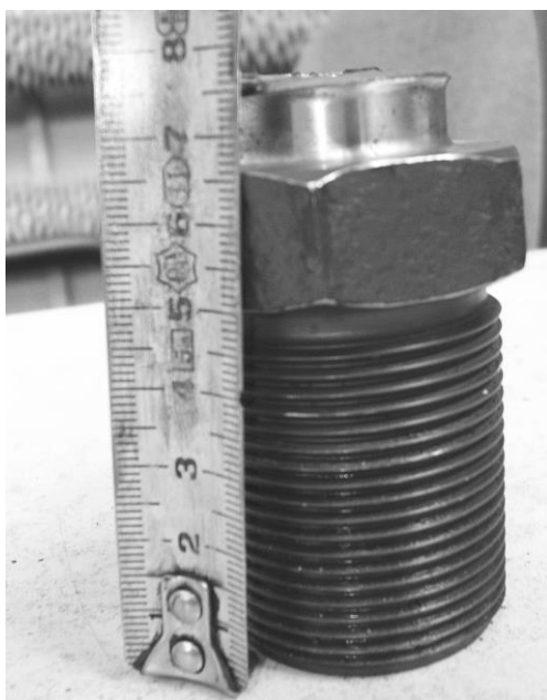
Rys.8. Widok pękniętego króćca
