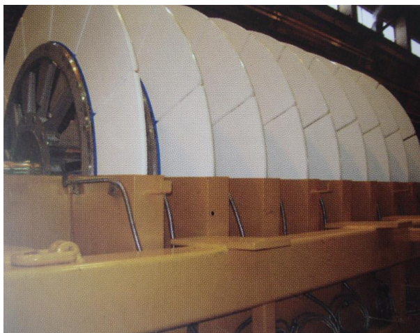
Rys.3. Nowo zabudowany filtr próżniowy tarczowy z przegrodą filtracyjną
