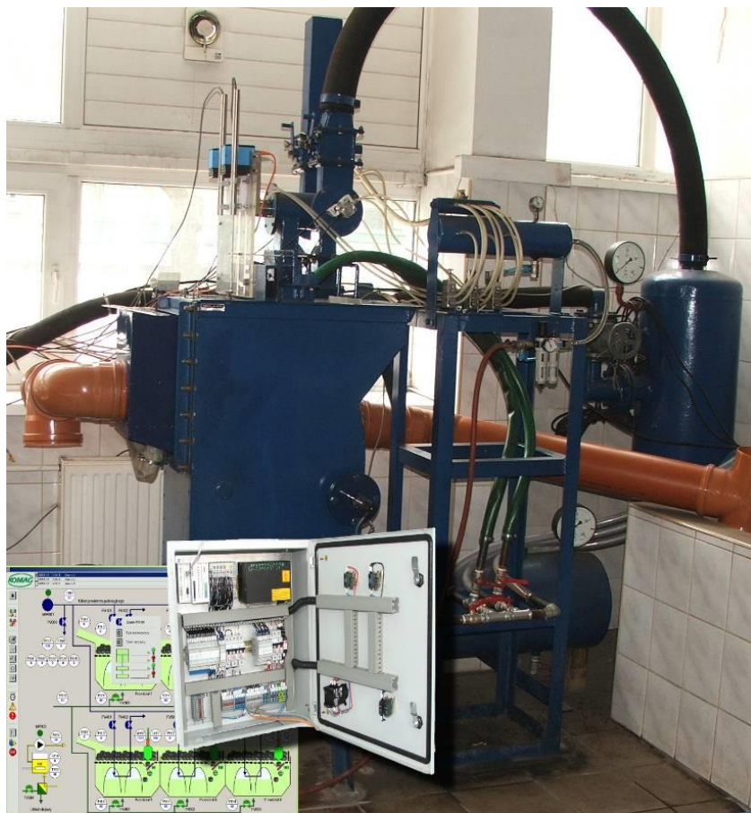
Rys.4. Badania laboratoryjne systemu sterowania osadzarką
