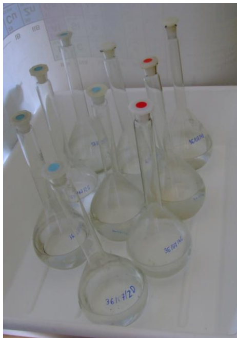
Rys.5. Próbkę odcieków z wyciekowania odpadów górniczych
