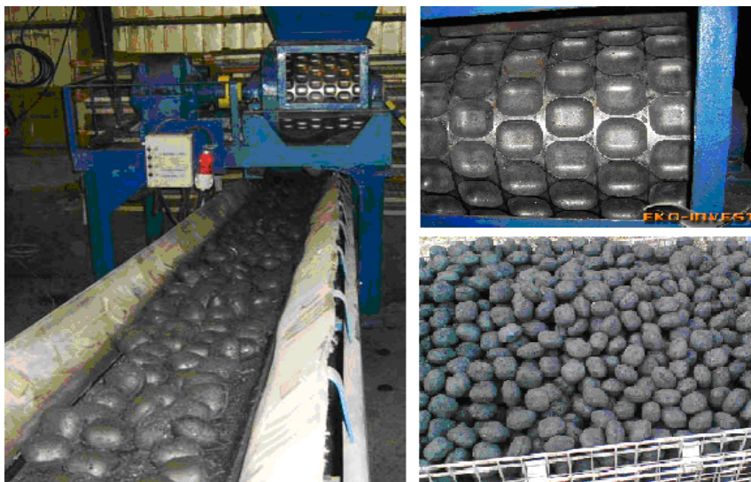
Rys.3. Wygląd brykietarki dwuwalcowej, walca i uzyskiwanych brykietów
