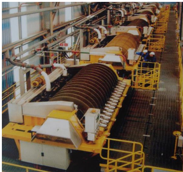
Rys.4. Filtr próżniowy tarczowy z przegrodą filtracyjną
