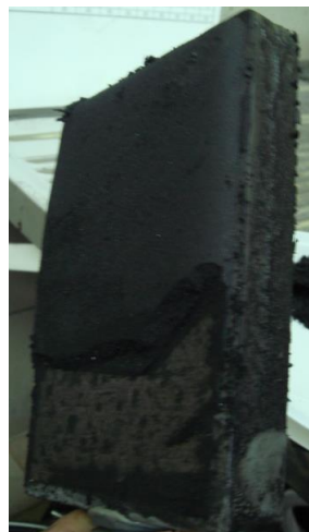
Rys.9. Widok placka filtracyjnego o grubości 6,0 mm; czas formowania – 21 sek, zawartość ciała stałego – 374,0 g/l
