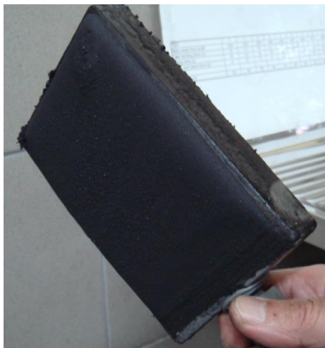
Rys.9. Widok placka filtracyjnego o grubości 6,0 mm; czas formowania – 21 sek, zawartość ciała stałego – 374,0 g/l
