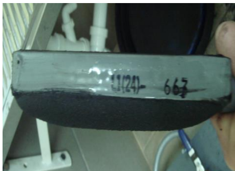
Rys.10. Widok placka filtracyjnego o grubości 9,5 mm; czas formowania – 21 sek, zawartość ciała stałego – 551,4 g/l
