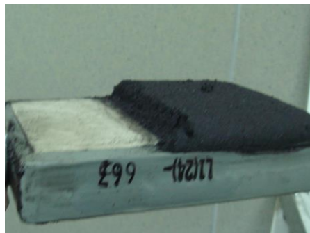
Rys.10. Widok placka filtracyjnego o grubości 9,5 mm; czas formowania – 21 sek, zawartość ciała stałego – 551,4 g/l
