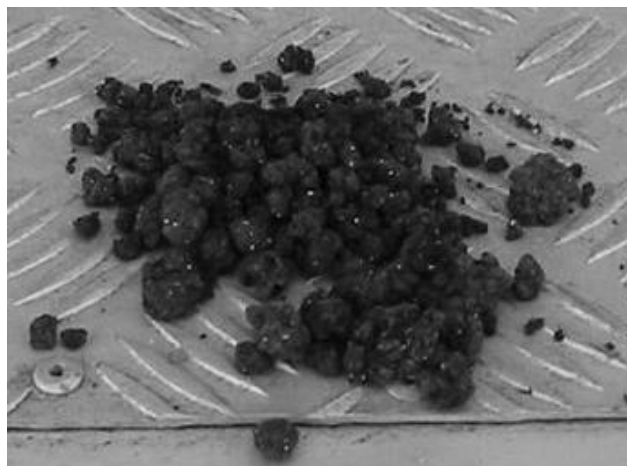
Rys.2. Suchy granulat osadowy wytworzony z wykorzystaniem mobilnej instalacji
