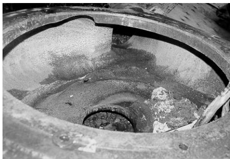
Rys.5. Zużycie elementów podzespołów komory roboczej spowodowane recyrkulacją wewnętrzną
