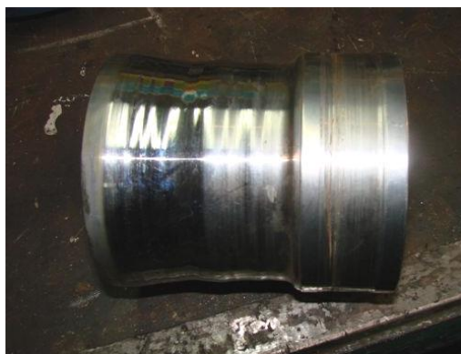
Rys.2. Typowe zużycie tulei wału w wyniku ugięcia wału
