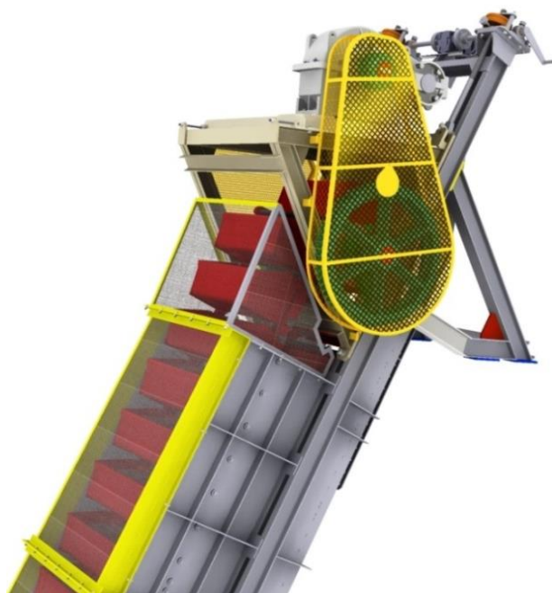
Rys.12. Przenośnik kubelkowy odwadniający B-1000 typu KOMAG [źródło: dokumentacja fotograficzna ITG KOMAG]
