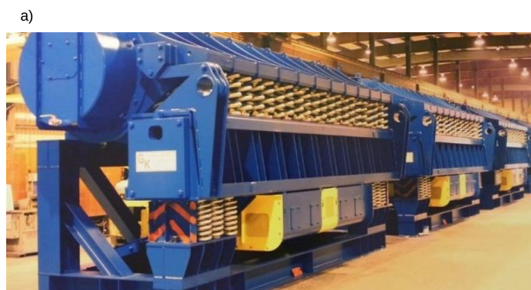
Rys. 12. Młyny wibracyjne firmy General Kinematics: a - w linii technologicznej w przemyśle górnictwym, b – jeden z prototypów młyna [25, 30]
