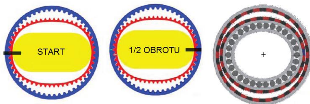
Rys. 8. Magnetyczna przekładnia harmoniczna 1-stopniowa, niskie przełożenie [1]
