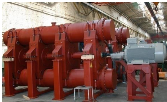
Rys. 15. Największe produkowane obecnie młyny wibracyjne: a – japońskiej firmy Masubo [19], b – niemieckiej firmy KHD Humboldt [21, 29] - produkowane również przez inne firmy
