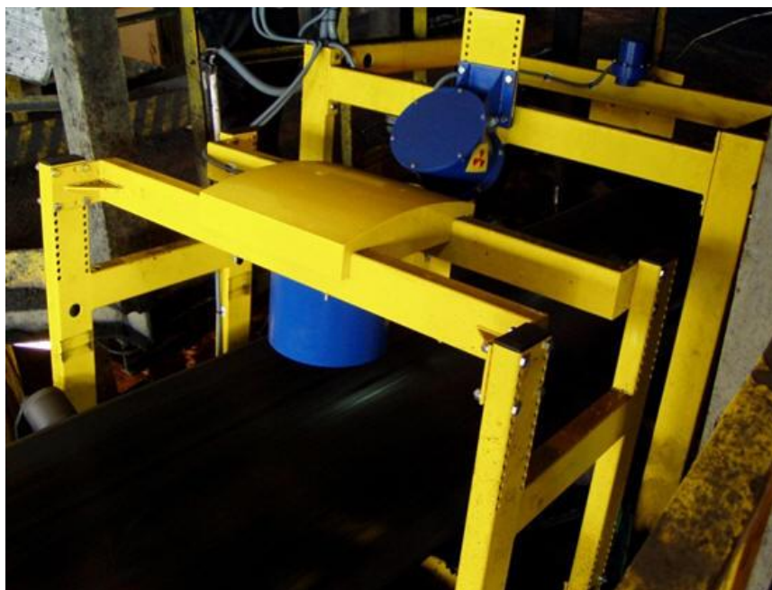
Rys.4. System ciągłego pomiaru parametrów jakości węgla WILPO C 532 hc [11]
