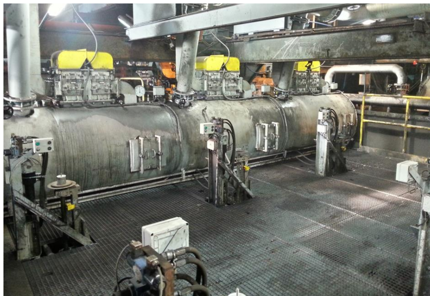
Rys. 2. Nowa osadzarka OM30 typu KOMAG wyposażona w system sterowania KOGASTER [źródło: dokumentacja fotograficzna ITG KOMAG]
