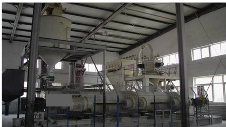
Rys. 11. Linia technologiczna mielenia cementu z młynem MZD 2200x1100 uruchomiona w 2011 roku [23, 24]
