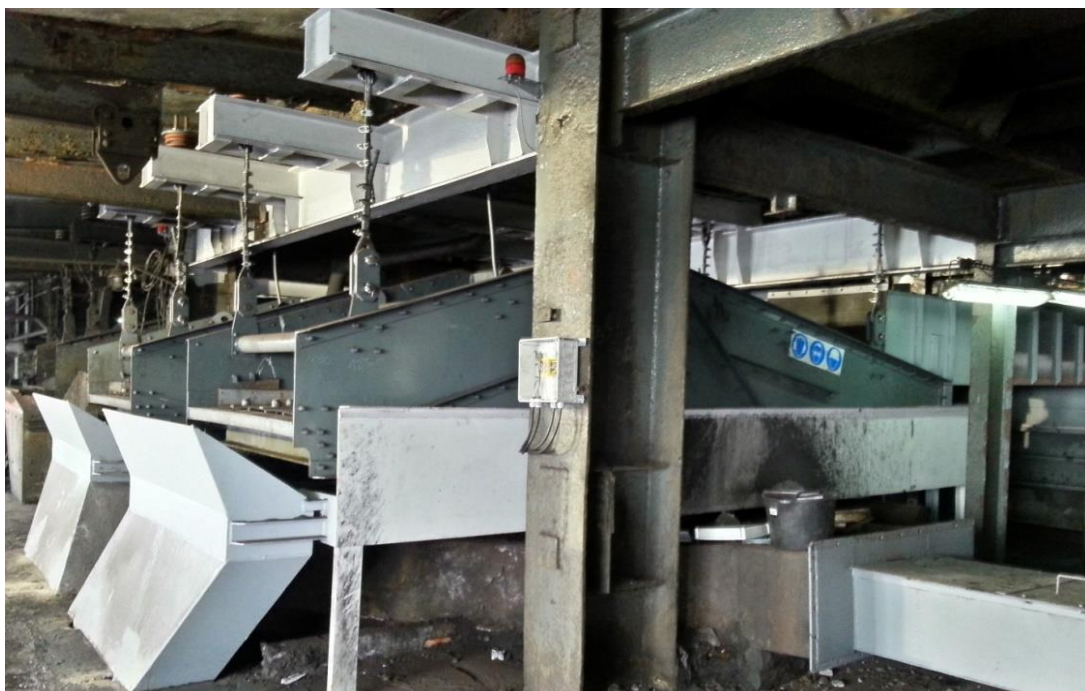
Rys.11. Przesiewacze wibracyjne WPT1 1,8 x 5,25 [źródło: dokumentacja fotograficzna ITG KOMAG]
