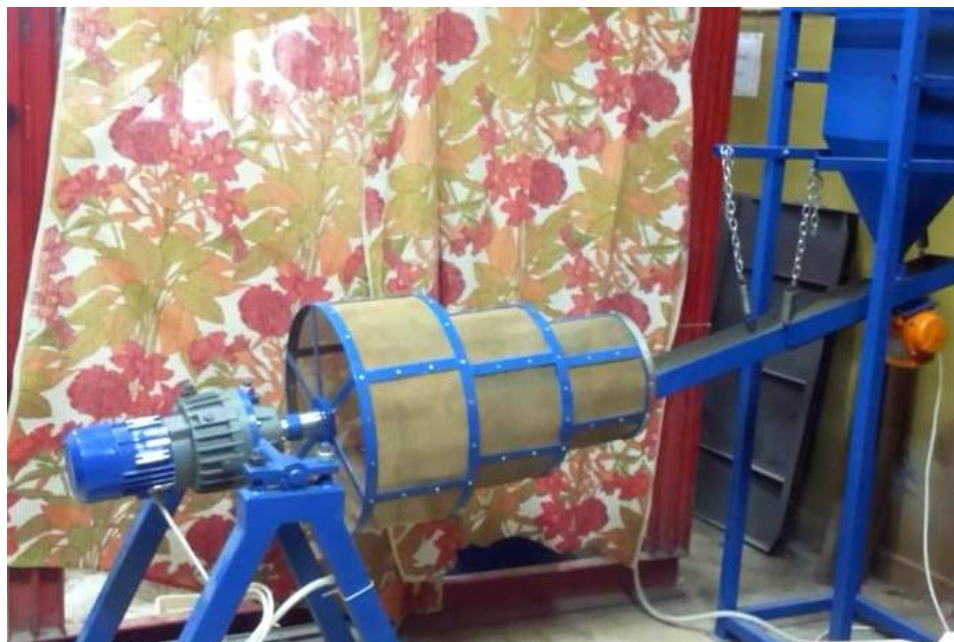
Rys. 7. Przesiewacz bębnowy - kaskadowy
