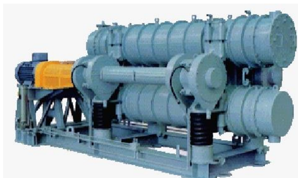
Rys. 15. Największe produkowane obecnie młyny wibracyjne: a – japońskiej firmy Masubo [19], b – niemieckiej firmy KHD Humboldt [21, 29] - produkowane również przez inne firmy
