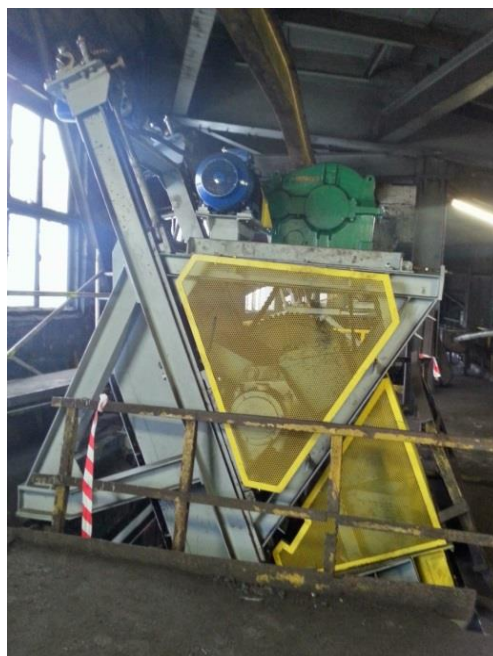
Rys.12. Przenośnik kubelkowy odwadniający B-1000 typu KOMAG [źródło: dokumentacja fotograficzna ITG KOMAG]
