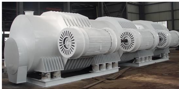
Rys. 10. Młyn wibracyjny firmy Lyvenus z wibratorem jednomasowym [23, 24]
