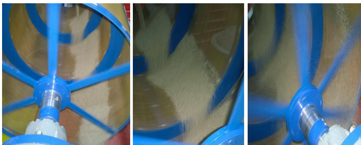
Rys. 8. Ruch ziaren w przesiewaczu kaskadowym
