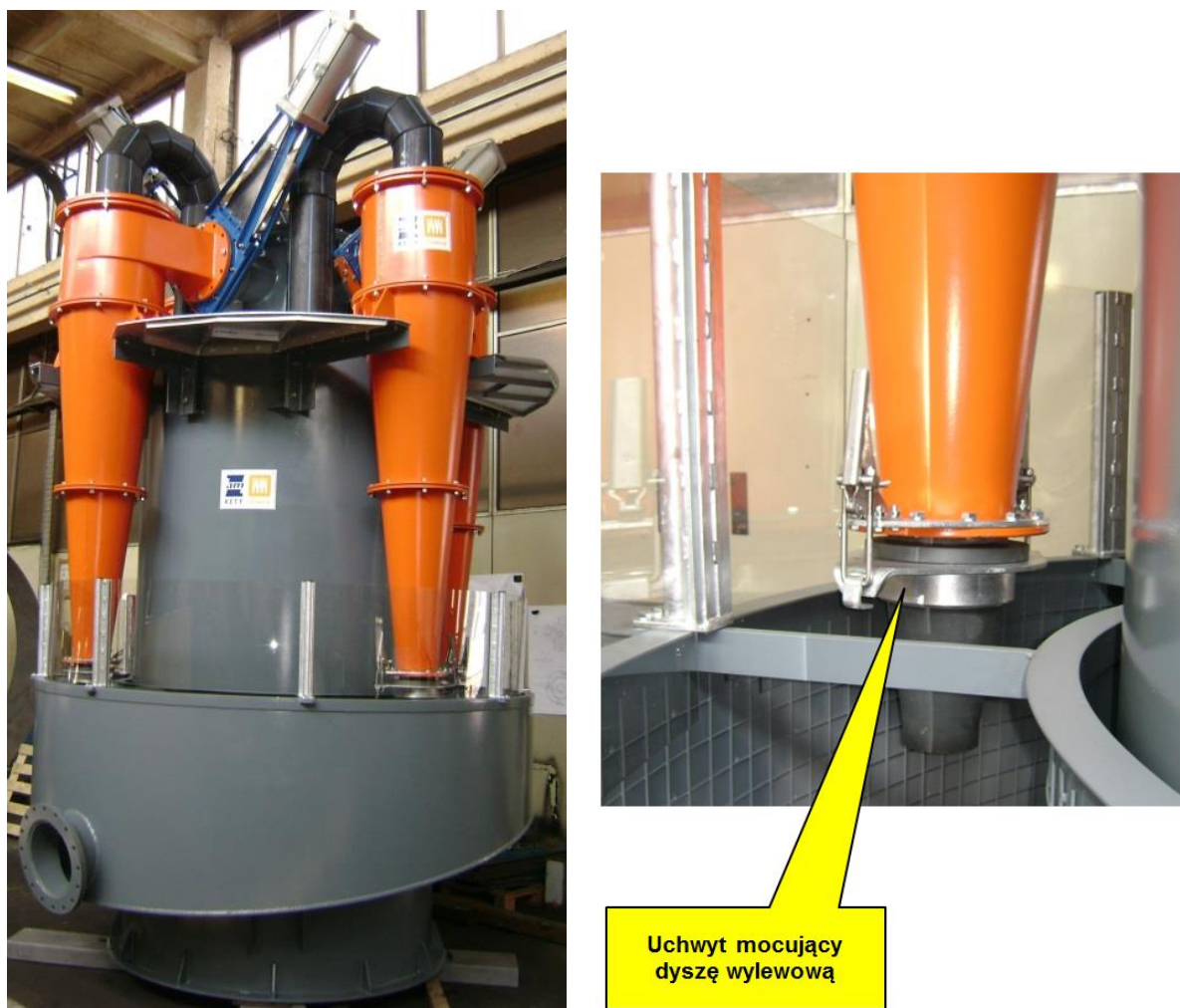
Rys. 7. Bateria 4 hydrocyklonów HC500/12°ZAM-IMN z nowatorskim systemem mocowania dyszy wylewowej [źródło: opracowanie własne]
