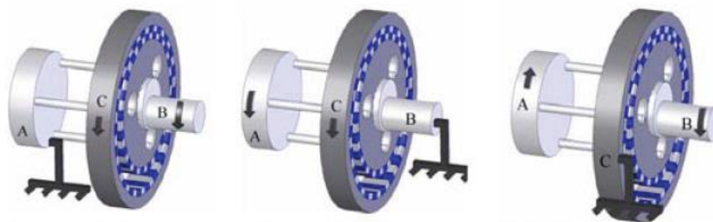
Rys. 9. Magnetyczna przekładnia cykloidalna 1-stopniowa, niskie przełożenie [1]
