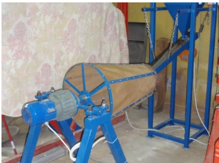
Rys. 3. Przesiewacz bębnowy - stożkowy
