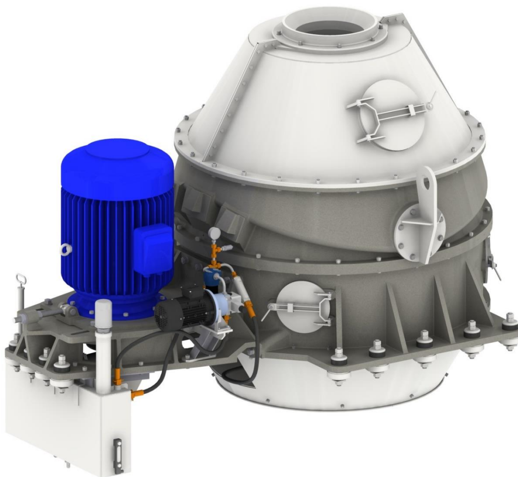
Rys. 3. Model 3D wirówki FK-NAEL 1 [4]
