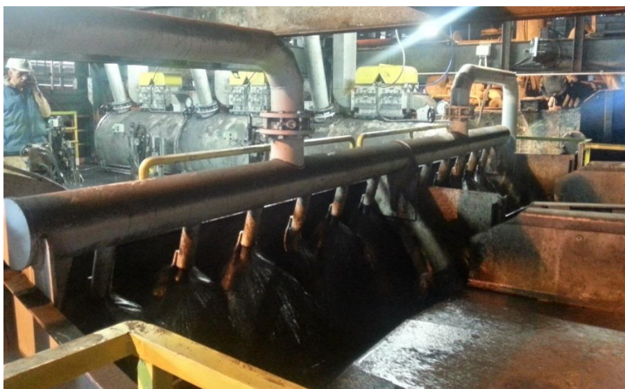
Rys. 8. Podajnik WPT 2,6 [źródło: dokumentacja fotograficzna ITG KOMAG]
