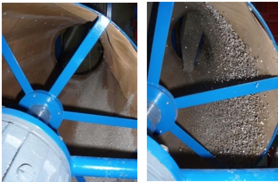
Rys. 4. Ruch ziaren w przesiewaczu stożkowym
