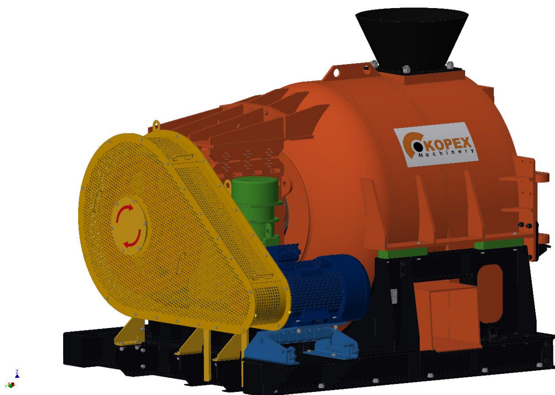
Rys. 1. Postać konstrukcyjna poziomej wirówki wibracyjnej WOW-1,3Z [4]
