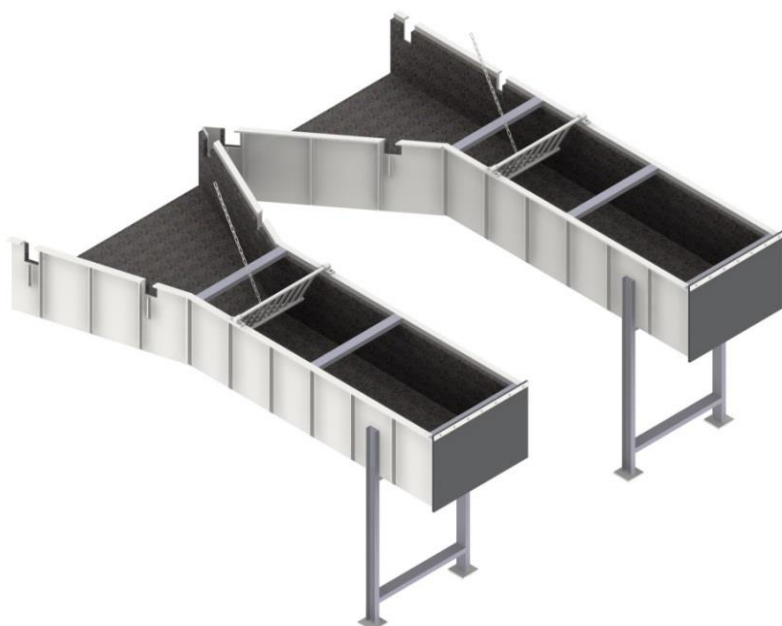
Rys. 10. Układ koryt spławnych koncentratu [11]
