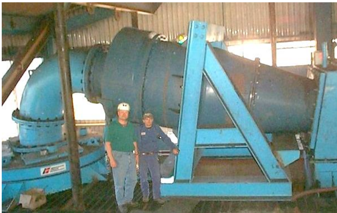
Rys. 5. Hydrocyklon Krebs D40B (Ø 1000 mm, 400 t/h, 1999 r.)
