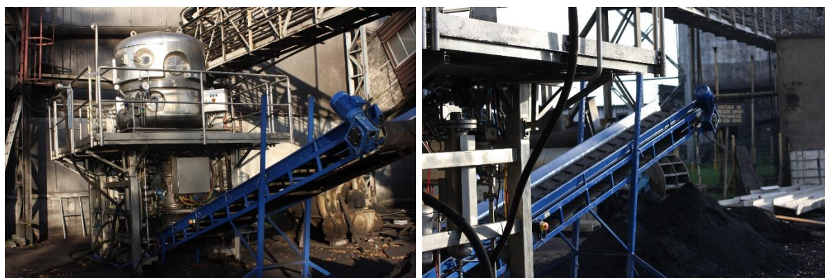
Rys. 6. Jednostka pilotowa HiBar (1m 2 filtr tarczowy) na płuczce węglowej KWK Pniówek zawartość wilgoci niezwiązanej płacka filtracyjnego poniżej 7% w/w
