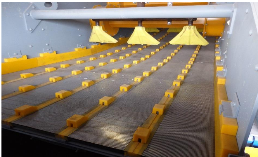
Rys. 3. Sita szczelinowe zgrzewane zabudowane w systemie PRO-CLIN na przesiewaczu PWP1-2Z-2,4x6,0
