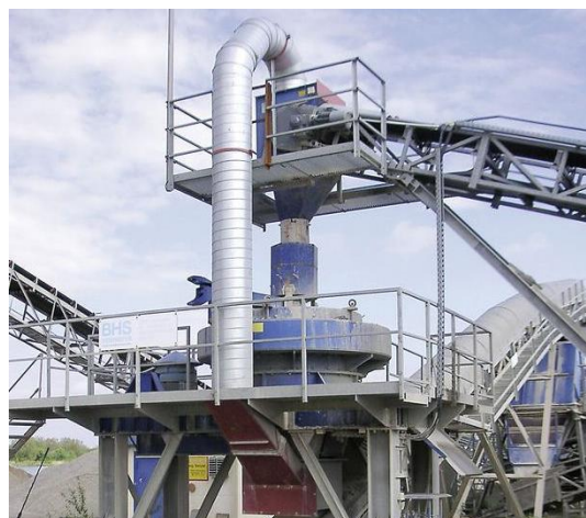
Rys. 9. Układ kruszenia z dozowaniem przenośnikiem taśmowym i cyrkulacją zapyłonego powietrza [19]
