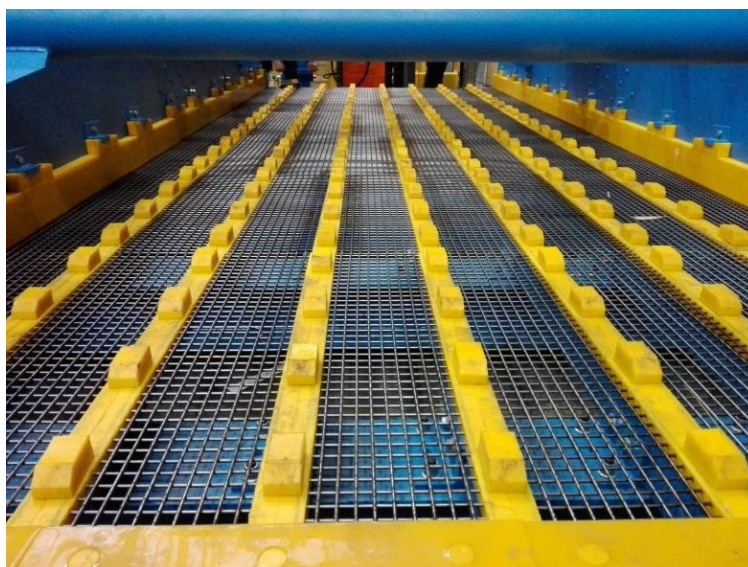
Rys. 3a. Przesiewacz wibracyjny PWP1 – 2Z-2,0 x 6,0 – pokład sitowy
