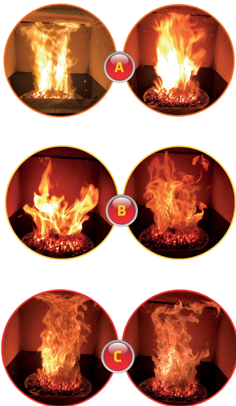
Rys. 5. Obraz płomieni podczas spalania ekogroszku (źródło: opracowanie na podstawie [7]) A – Zbyt duża ilość tlenu, B – Zbyt mała ilość tlenu, C – Optymalna ilość tlenu
