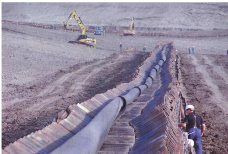
Rys. 1. Nadmiernie zużyta taśma po zluźnieniu zwinięta w rurkę [1]
