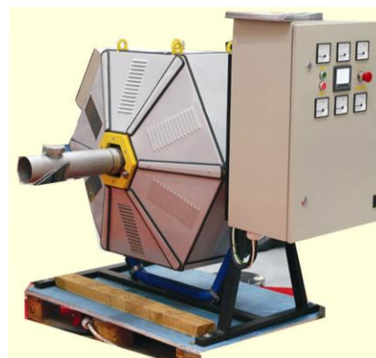
Rys. 3. Młyn elektromagnetyczny oferowany przez firmę Wolff: a – widok od strony wylotu, b – od strony wlotu materiału mielonego [14]
