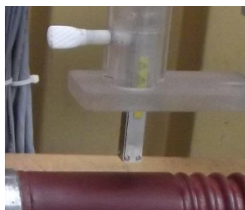
Rys. 10. Zastosowana sonda kompensacyjna do pomiaru potencjału pola elektrycznego
