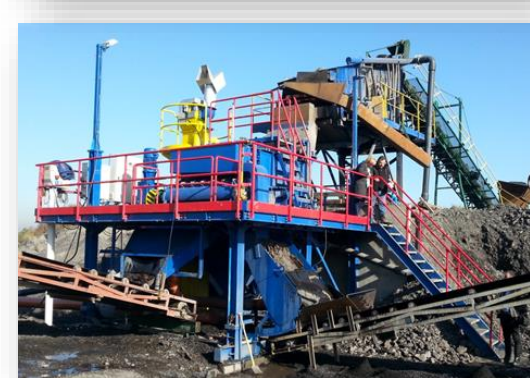
Klasyfikator pulsacyjny K-102 do rekultywacji składowiska pokopalnianego
