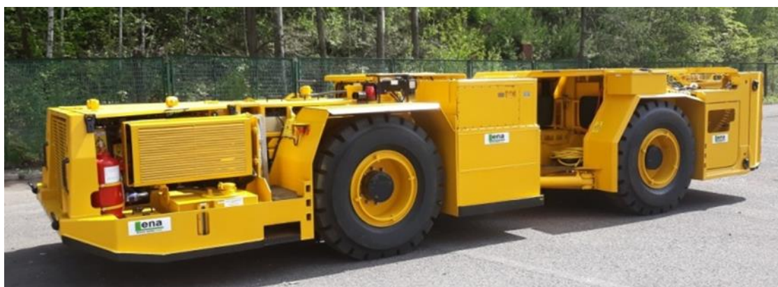
Rys. 9. Wóz strzelniczy SWS-1700ENB produkcji LENA-Wilków [8]
