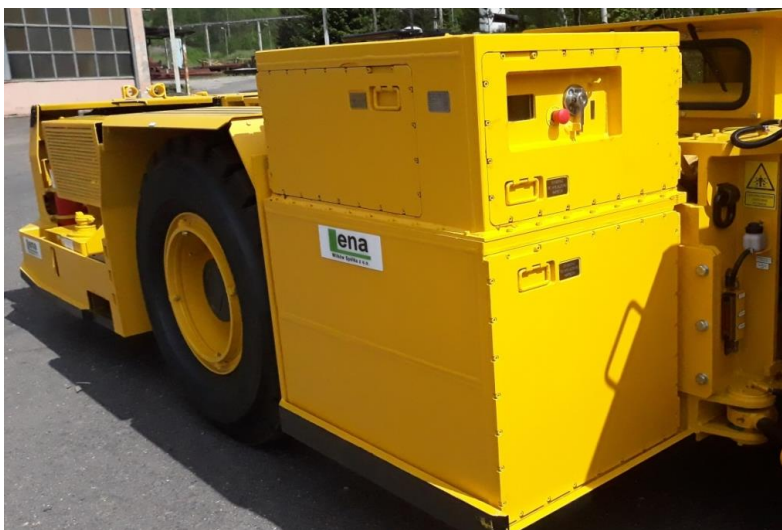
Rys. 7. Zespół zasilania bateryjnego (wykonanie 3) [5]
