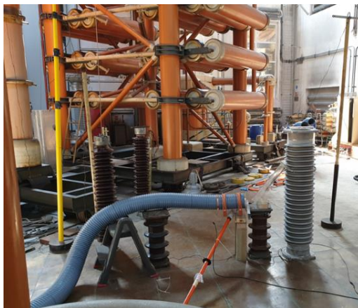
Rys. 14. Stanowisko badawcze do badania technologii MVC w laboratorium Instytutu Energetyki w Warszawie
