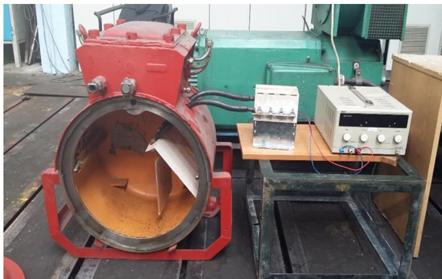
Rys. 8. Stanowisko do badań na zwarcie na zaciskach ogniwa
