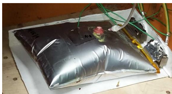
Rys. 12. Ogniwo w czasie próby na przeładowanie
