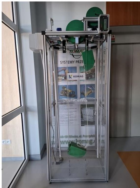
Rys. 4. Demonstrator technologii grawitacyjnego magazynu energii z cięgnem zamkniętym z wieloma naczyniami napełnianymi wodą wykonany w ITG KOMAG
