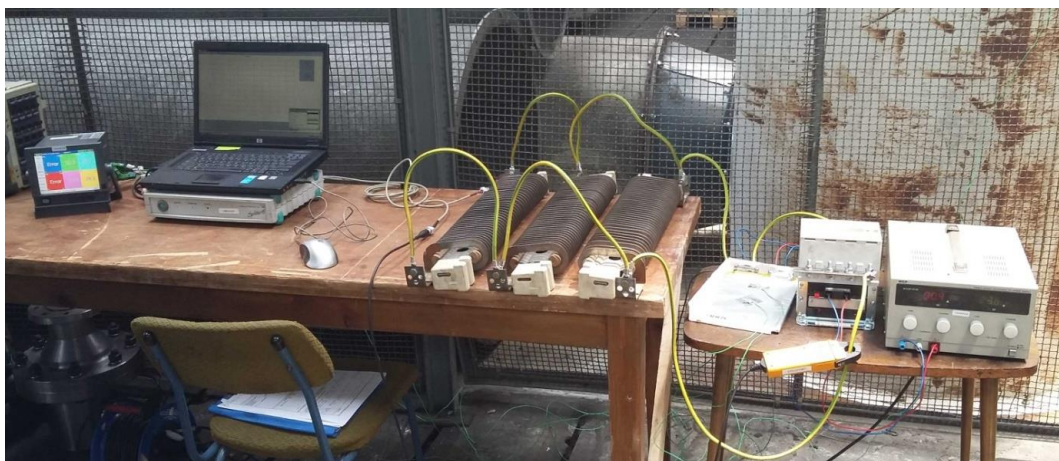
Rys. 4. Stanowisko do badań na głębokie rozładowanie
