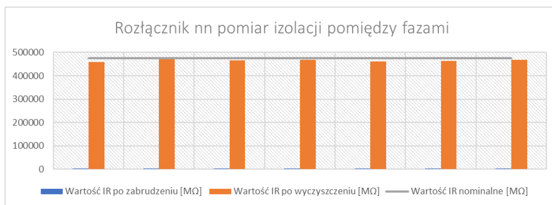
Rys.10. Wyniki pomiarów rezystancji izolacji pomiędzy fazami dla szafy sterowniczej
