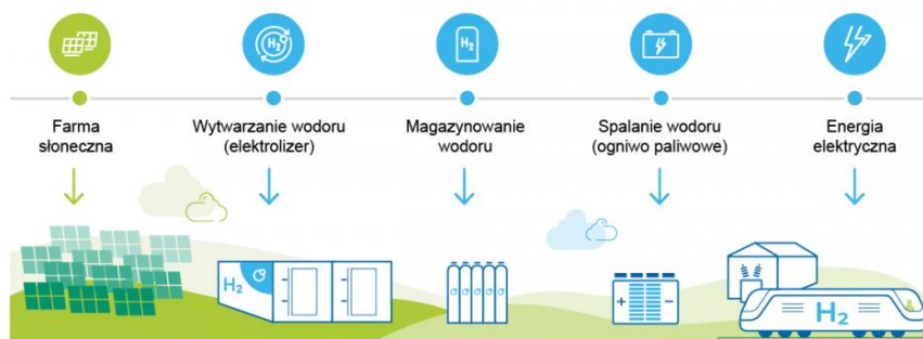
Rys. 3. Przykładowy proces produkcji i wykorzystania zielonego wodoru [Źródło: 23]
