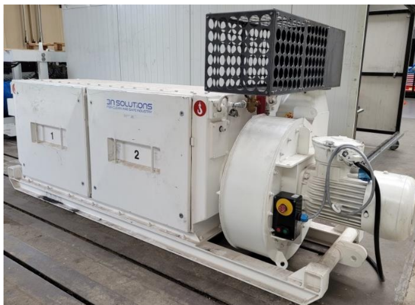
Rys. 6. Urządzenie odpylające stosowane w systemie UCT
