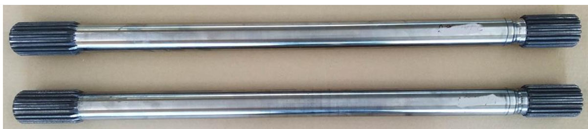
Rys. 3. Wałki skrętne stosowane w kombajnach ścianowych
