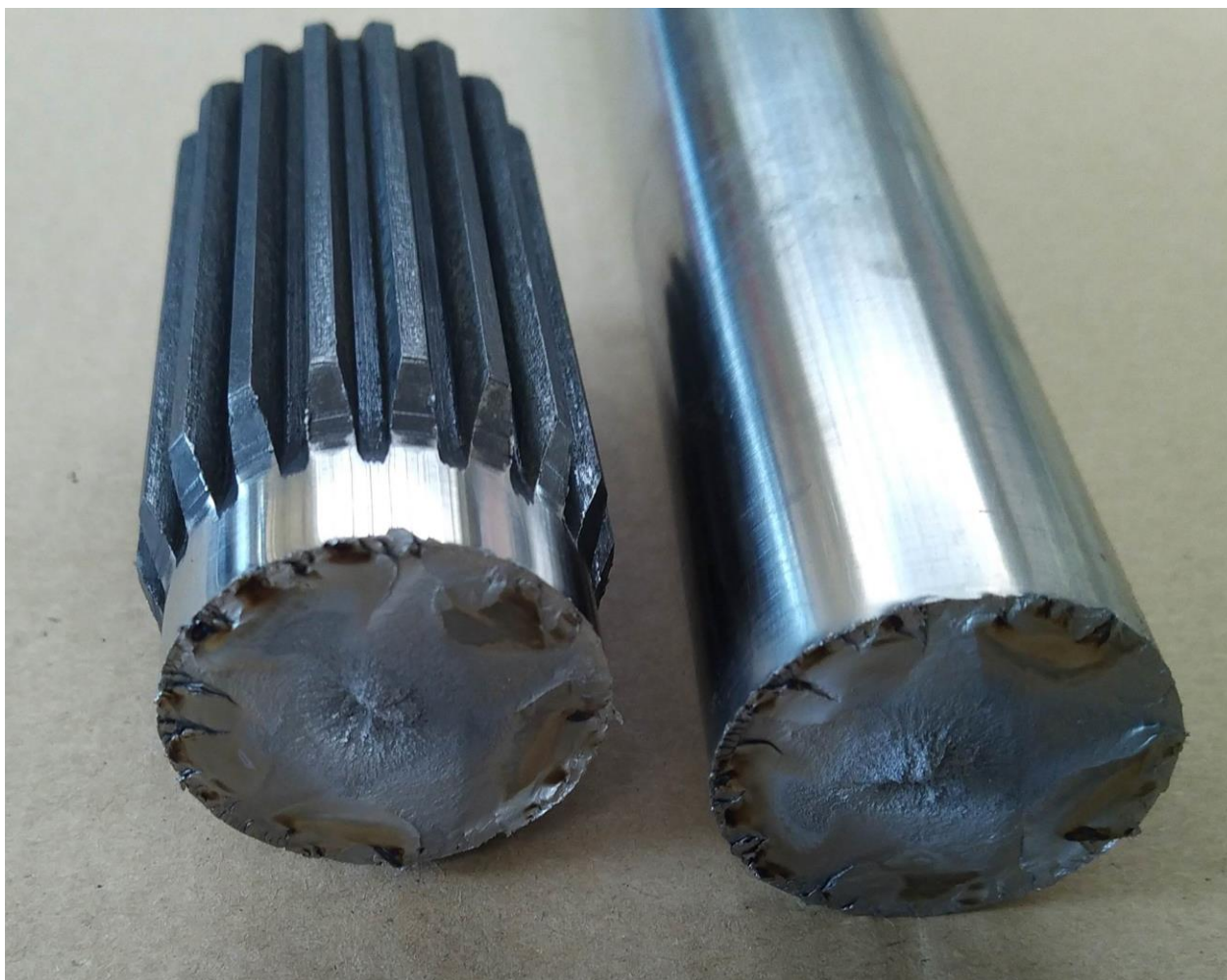
Rys. 4. Przełom zerwanego wała skrętnego wykonanego wadliwie
