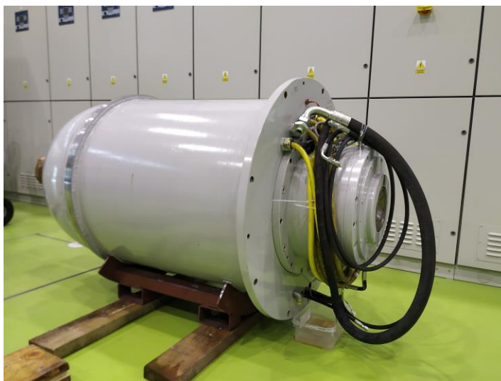
Rys. 7. Obwód elektromagnetyczny prądnicy oraz hydrogenerator: a) obwód elektromagnetyczny hydrogeneratora 220 kVA, b) hydrogenerator dostarczony do elektrowni wodnej [źródło – opracowanie Łukasiewicz – GIT]
