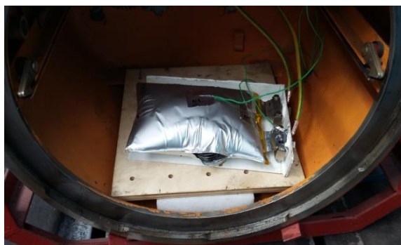
Rys. 13. Ogniuwo po próbie na przeładowanie
