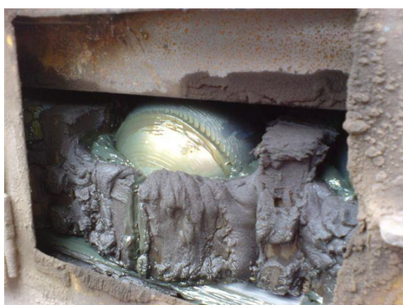
Rys. 4. Szczegół kuli po rocznym stosowaniu smaru CERAN HVS
