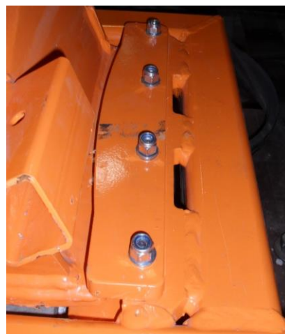
Rys. 5. Rama zabezpieczenia przed przeciążeniem z bezpiecznikiem śrubowym (z zaznaczonymi czujnikami przemieszczeń): 1 - strona lewa (pl); 2 - strona prawa (pp); 3 – strona prawa po przeciwnej stronie (tp); F – położenie siły obciążającej przy równomiernym obciążeniu zgarnianym śniegiem (źródło: opracowanie własne)
