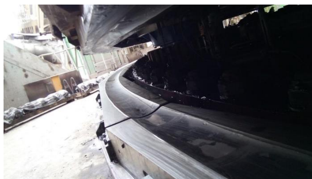
Rys. 9. Smarowana bieżnia podwozia po czterech latach eksploatacji
