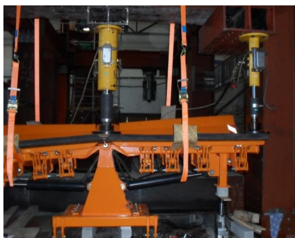
Rys. 3. Układ pomiarowy z dwoma siłownikami hydraulicznymi (źródło: opracowanie własne)
