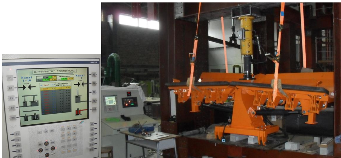
Rys. 1. Ogólny widok stanowiska badawczego z zamocowanym pługiem z pulpitem sterowniczym ALPS 300 (źródło: opracowanie własne)
