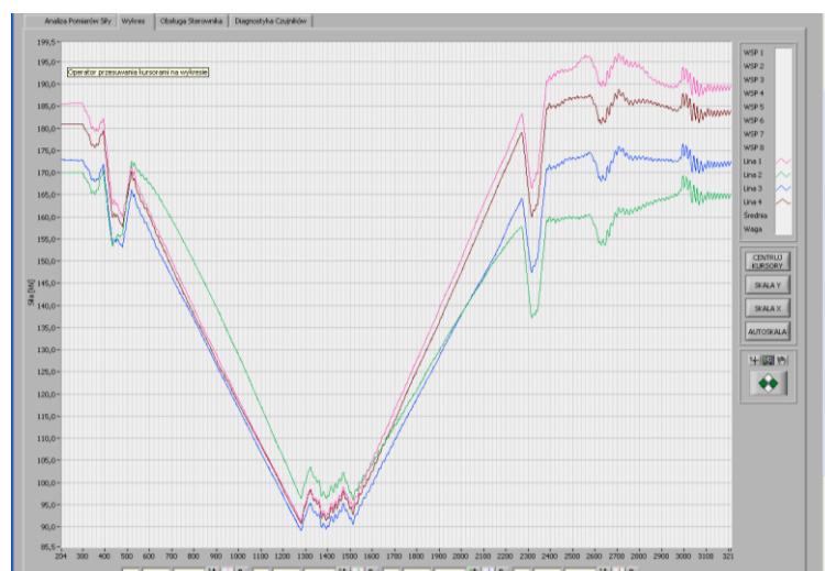
Rys. 8. Przejazd pustymi skipami zarejestrowany w dniu 30 czerwca 2019 r. Pomiar po pierwszej korekcie (noże ustawione do listwy bazowanej na stojakach hamulcowych). Rozrzut sił w linach 25 [kN] [9]
