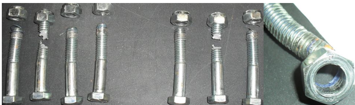
Rys. 12. Obraz uszkodzenia (zerwania) śruby lub zwojów śruby i nakrętki (źródło: opracowanie własne)
