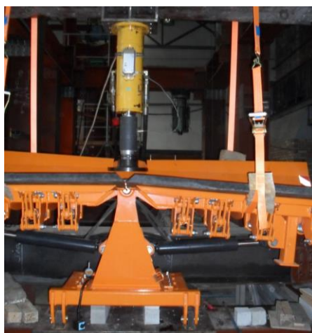
Rys. 2. Pług zamocowany na stanowisku badawczym z widocznym sworzniowym, trójpunktowym podparciem i siłownikiem hydraulicznym do zadawania obciążeń (źródło: opracowanie własne)
