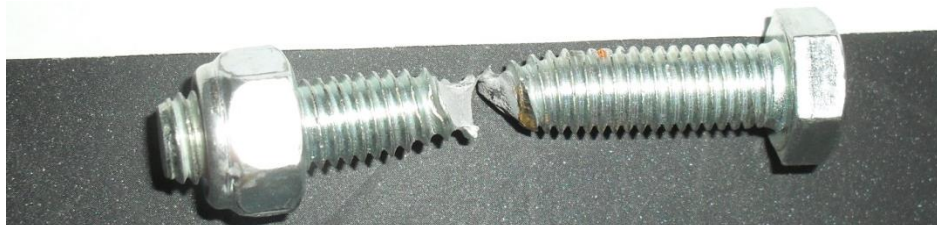
Rys. 10. Obraz uszkodzenia (zerwania) śruby z gwintem na całej długości (źródło: opracowanie własne)
