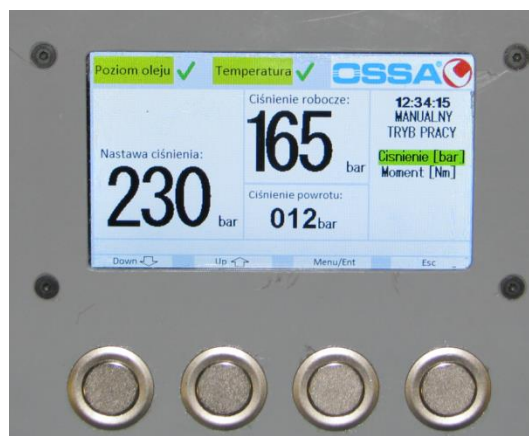
Rys. 7. Podstawowy ekran wyświetlany podczas pracy agregatu
