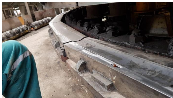
Rys. 10. Smarowana bieżnia podwozia po czterech latach eksploatacji
