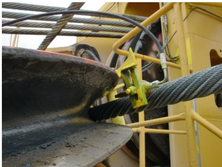
Rys. 12. Płynne smarowanie kół podnośnika wyciągnika K 2000
