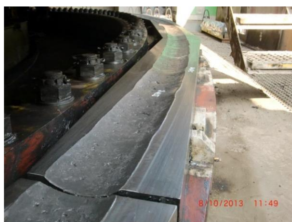
Rys. 6. Uszkodzenie bieżni podwozia
