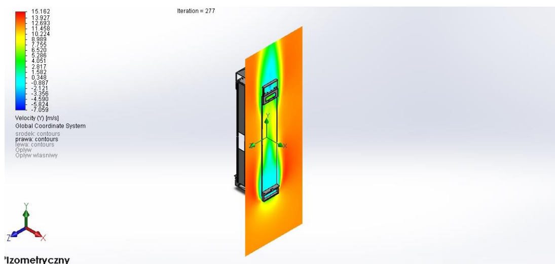
Rys. 7. Opływ powietrza wokół prawej części klatki wielkogabarytowej z osłonami aerodynamicznymi w rzucie izometrycznym
