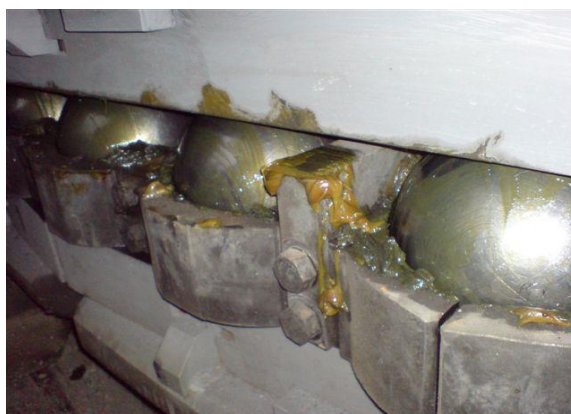
Rys. 1. Szczegół łożyska – oryginalny smar
