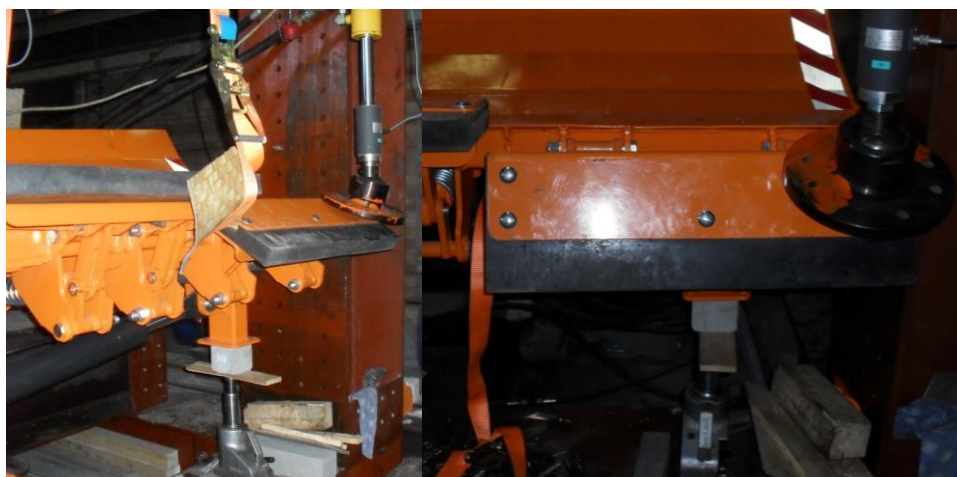
Rys. 24. Segment lemiesza w trakcie kolejnych faz odchylania (źródło: opracowanie własne)
