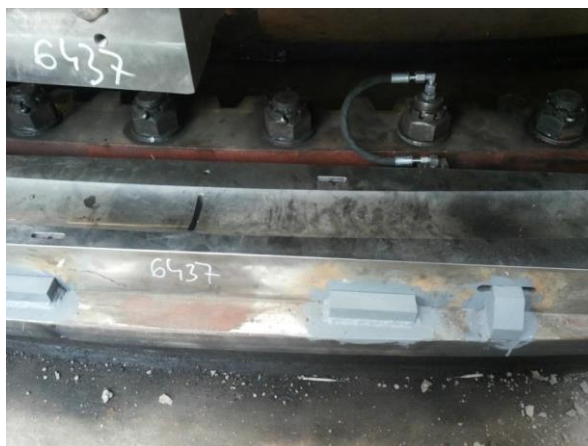
Rys. 8. Nowo zaprojektowany segment bieżni podwozia
