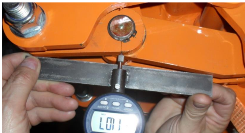
Rys. 23. Sposób pomiaru strzałki mechanizmu odchylania lemiesza (źródło: opracowanie własne)
