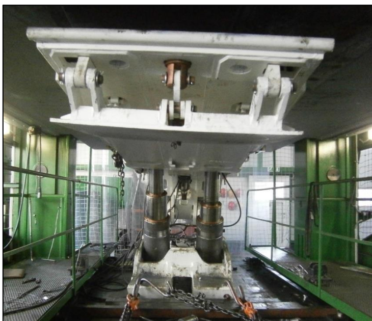
Rys. 1. Sekcja prototypowa podczas badań stanowiskowych
