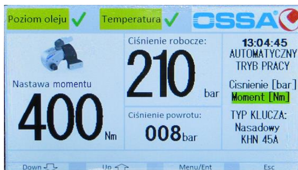
Rys. 10. Podstawowy ekran wyświetlacza podczas regulacji momentem
