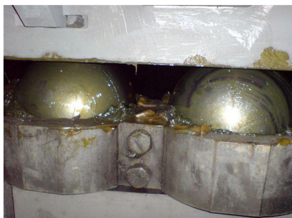
Rys. 3. Stan łożyska smarowanego nowym smarem
