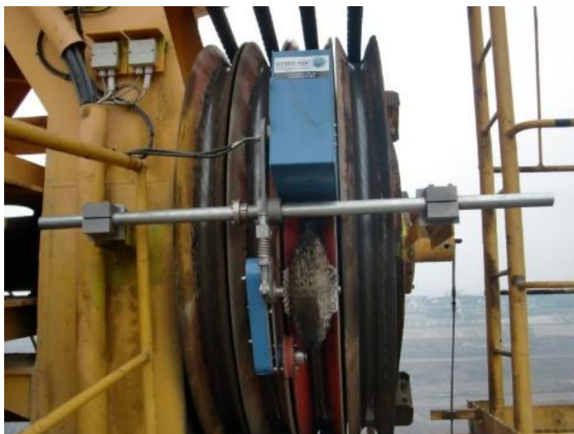
Rys. 13. Smarowanie stykowe kół podnośnika wyciągnika KV KU 800
