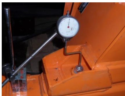
Rys. 4. Układ pomiarowy odkształcenia śrub (źródło: opracowanie własne)
