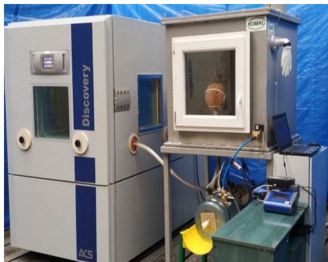
Rys. 9. Stanowisko do badania półmasek utworzone w ramach projektu ROCD [35]
