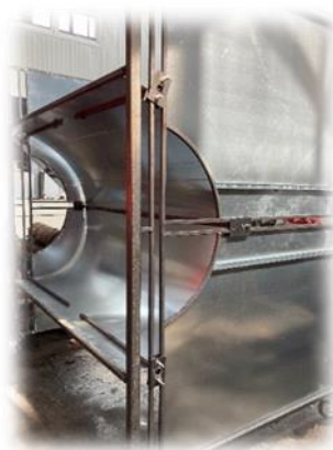
Rys. 9. Widok modelu calizny przodka chodnikowego, prototypu stanowiska do badania skuteczności gaszenia i niedopuszczania do zapłonu gazu przez instalację zraszającą kombajnów chodnikowych
