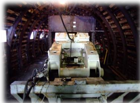
Rys. 3. Głowica urabiająca kombajnu chodnikowego z zabudowaną powietrzno-wodną instalacją zraszającą, poddawana ocenie na stanowisku badawczym, zlokalizowanym w KD Barbara [10]
