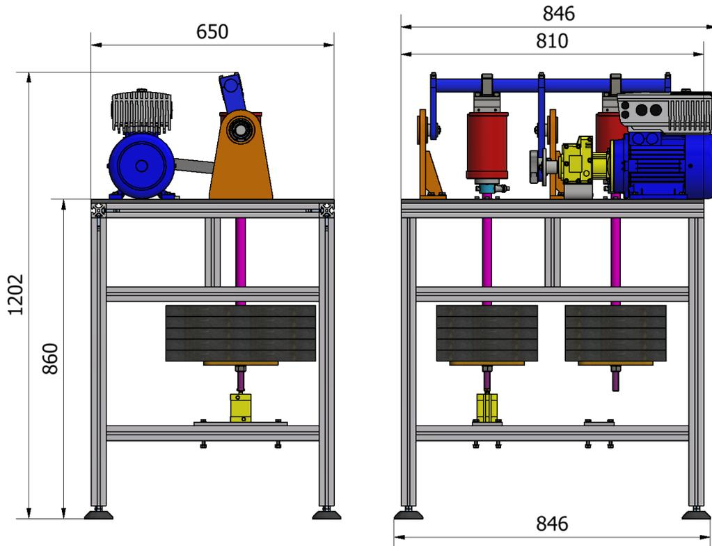
**Fig. 6.** Test stand dimensions
