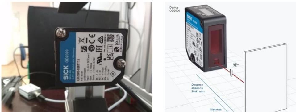
Fig. 4. Sensor SICK OD2000-0501T15
