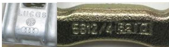
Obr. 37 Kovová súčiastka označená reliéfnymi a gravírovanými kódmi
