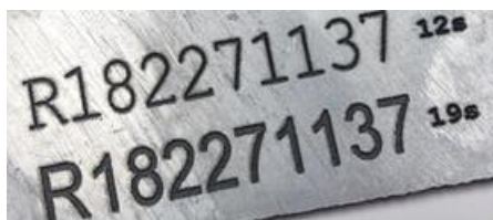
Obr. 40 Kovový štítok – hlboké gravírovanie (Pannier 2019a)
