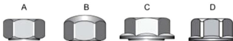
Obr. 46 Druhy IstLock matic: a – šesťhranná matica, b – šesťhranná klobúčková matica, c – šesťhranná matica s prírubou, d – Torx matica (Dominik, Žmind'ák 2011).
