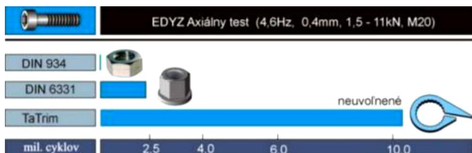
Obr. 47 Test vibrácií EDYZ (Ferodom 2015).
