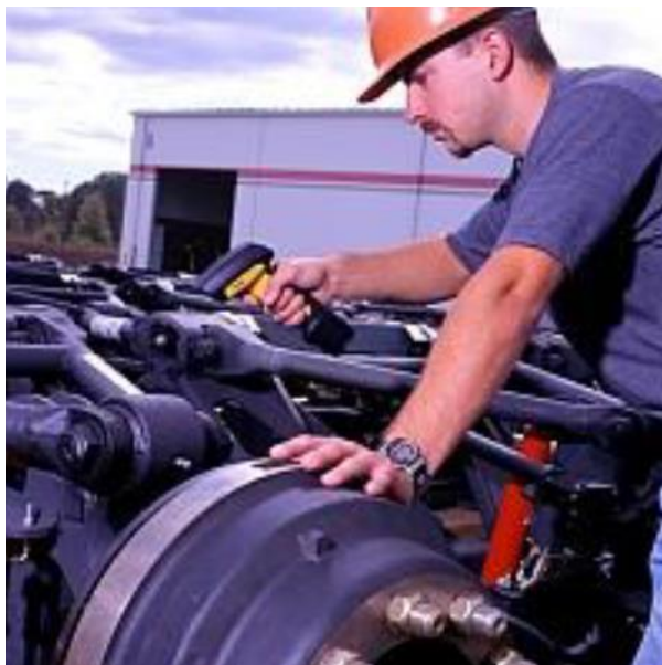
Obr. 32 Priemyselná aplikácia čiar. kódov – proces montáže
