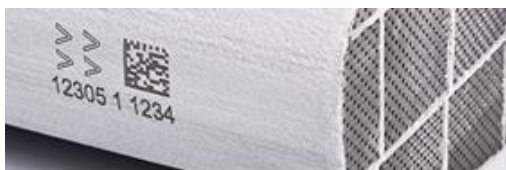
Obr. 41 Keramická súčiastka označená laserom (Pannier 2019)
