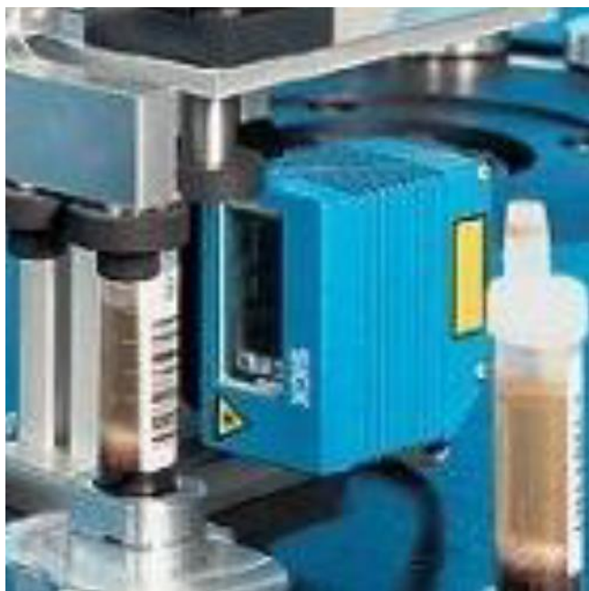
Obr. 33 Stacionárny snímač namontovaný na výrobnéj linke
