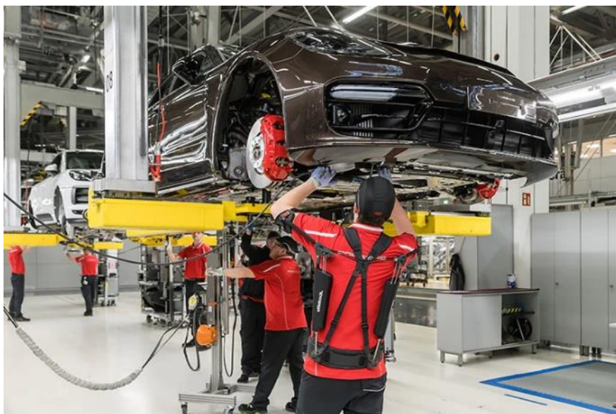
Obr. 12 Porsche – testovanie exoskeletu Paexo (Hitch 2020)
