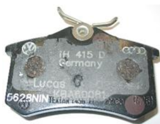
Obr. 36 Brzdová doštička s vytlačenými informáciami (biela farba)
