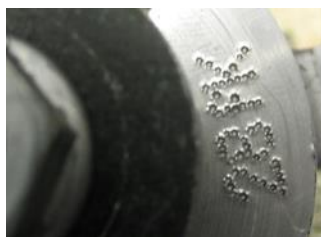
Obr. 35 Alfanumerický kód vytvorený bodovým značením
