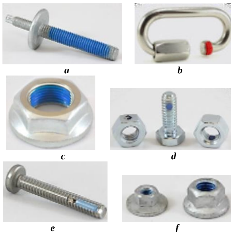
Obr. 58 Nylok produkty: a) modrá nylonová škvŕna, b) červená nylonová škvŕna, c) vysokovýkonný samozverný nylonový nepriepustný prvok, d) modrá nylonová peleta, e) modrý nylonový pruh, f) Nylok poistná matica (NYLOK 2020).
