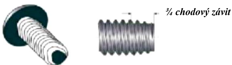
Obr. 56 TEK skrutka s trojuholníkovým prierezom (Dominik 2012)
