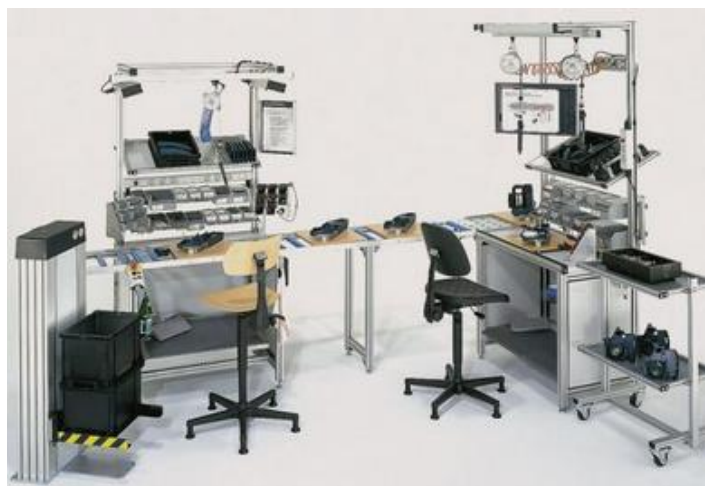
Obr. 2 Pracovné stanice pre ručnú montáž prepojené paletovým dopravníkom (Boschrexroth 2024a)
