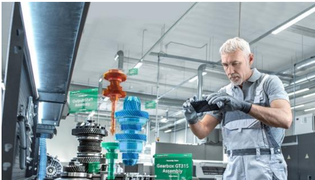
Obr. 25 Aplikácia rozšírenej reality v montáži (Rockwell Automation 2024)
