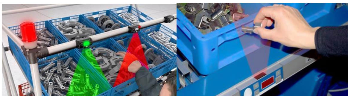
Obr. 14 „Pick to light“ s kontrolou správneho siahnutia (Matthewsautomation 2024, Luca 2024)
