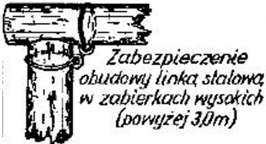
Rys. 13. Zabezpieczanie stojaka przed wybiciem w wysokiej zabierce.
